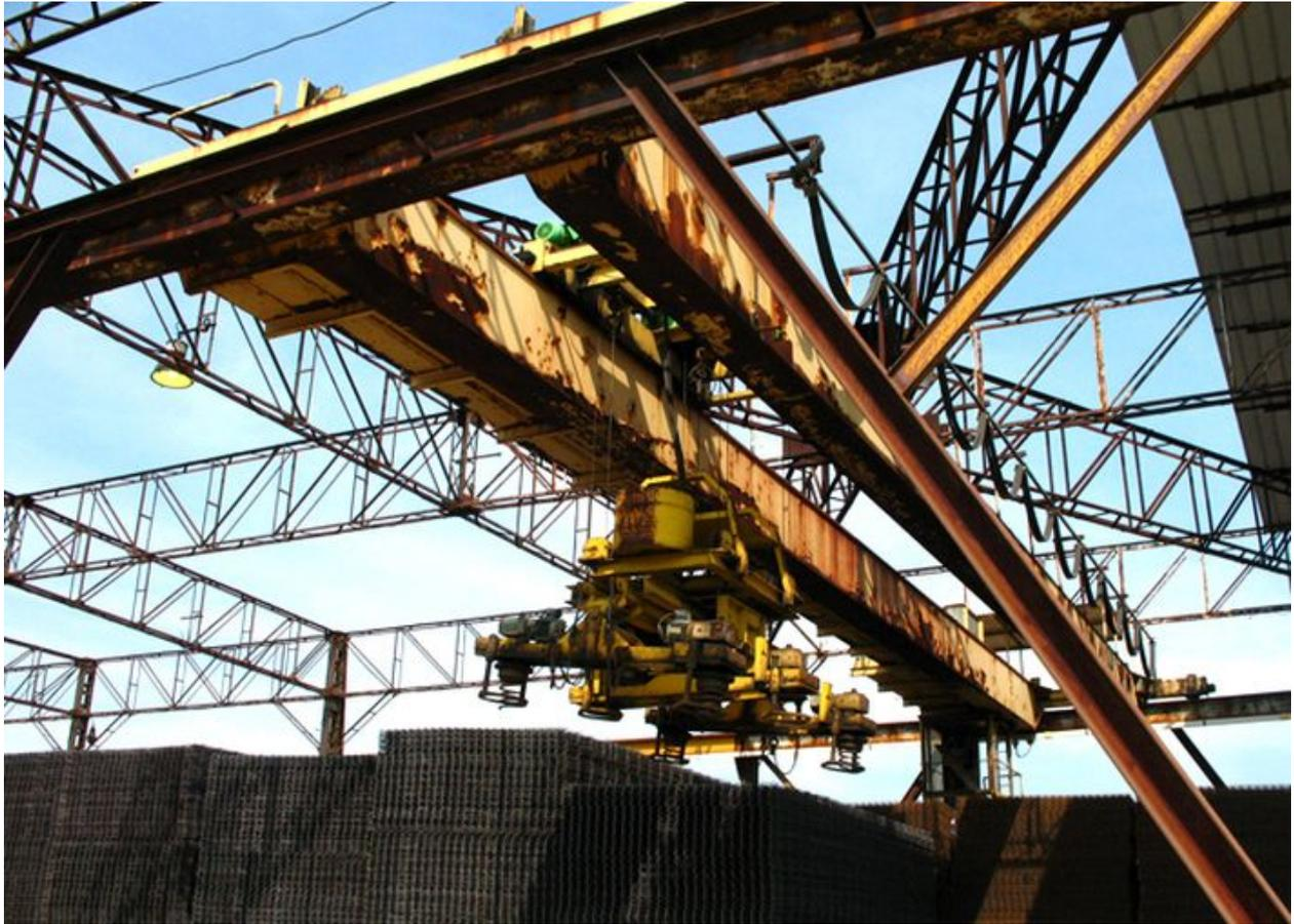
Le spirigrip agrippe les plaques de treillis-soudés pour les chargements.
