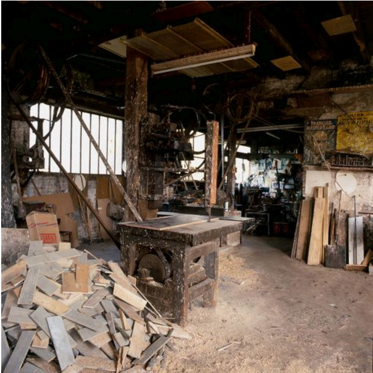
Intérieur de l'atelier de sciage, vue d'une raboteuse.
