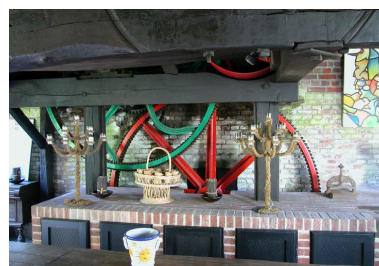
Le mécanisme principal de transmission de la force hydraulique. Phot. Bertrand Fournier IVR22_20046003064NUCA
