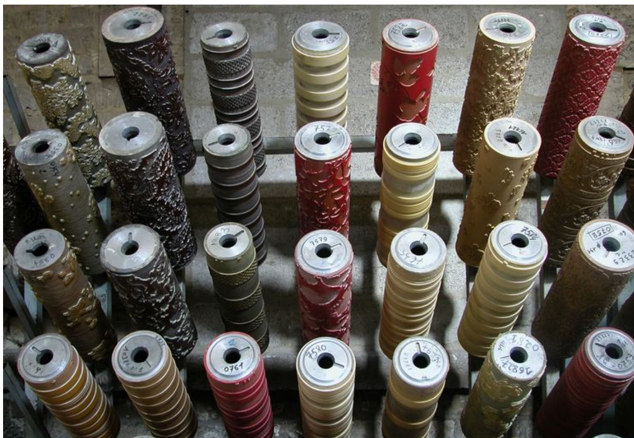
Détail des cylindres de gaufrage.
