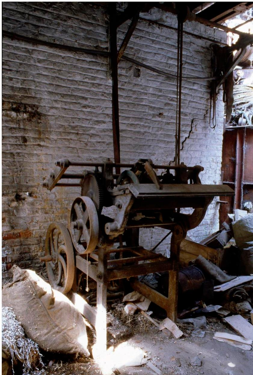
Atelier de fabrication. Machine à rogner (rogneuse).
