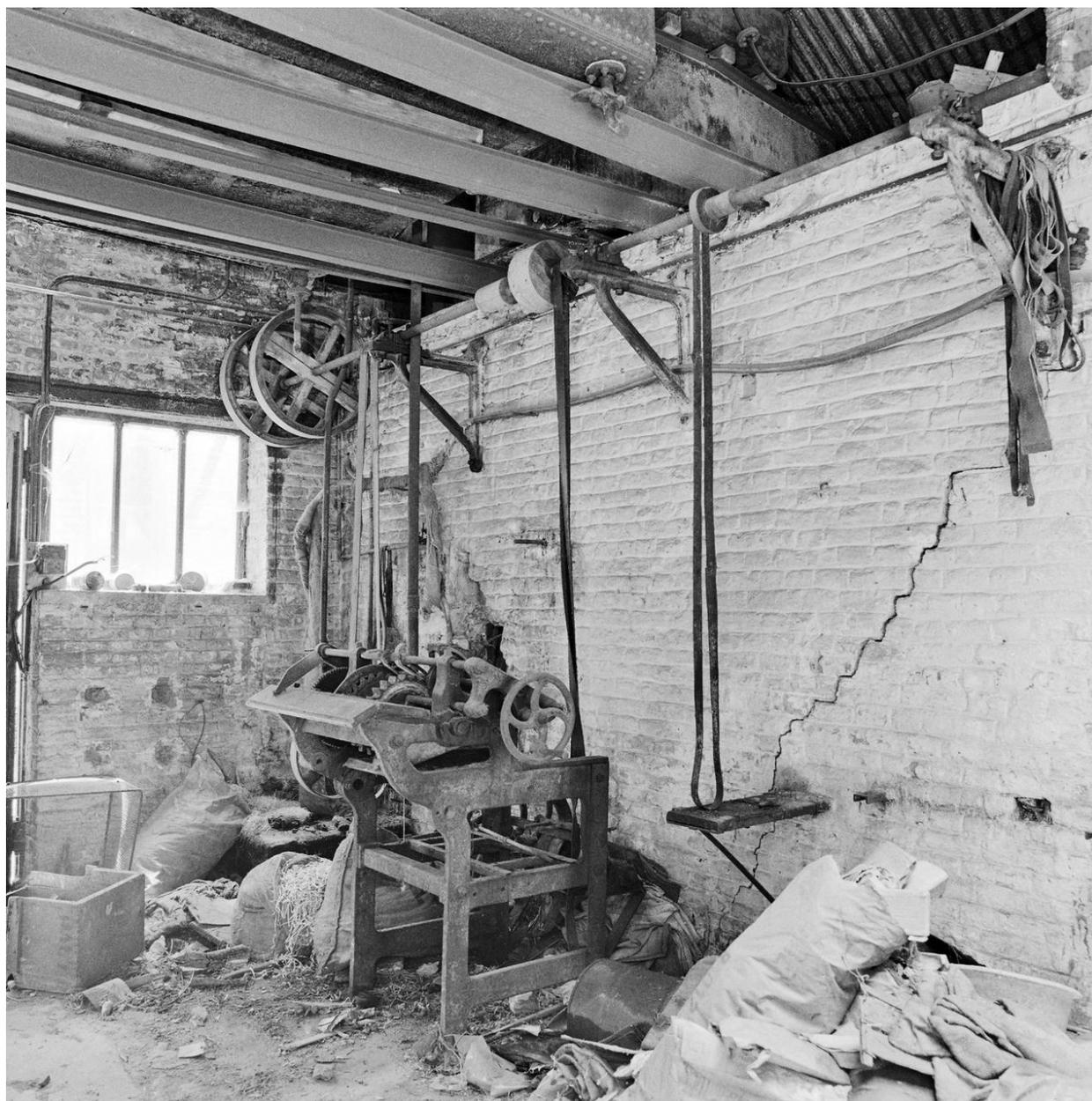
Atelier de fabrication. Machine à rogner (rogneuse) et fond de réservoir d'eau.
