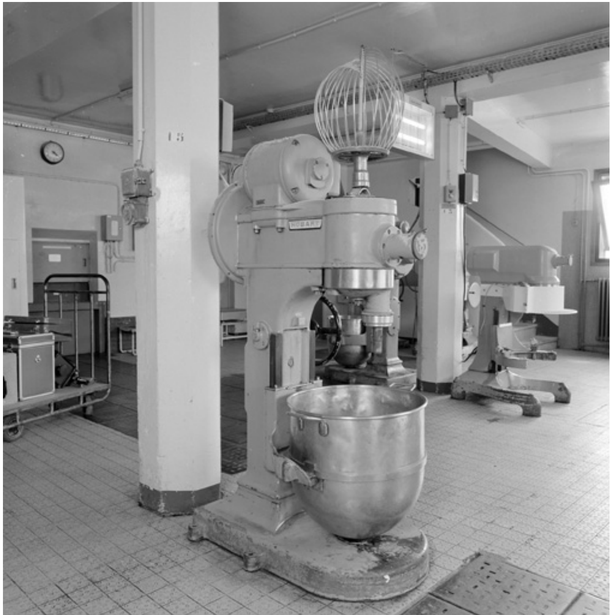
Machine à émulsionner de fabrication française, compagnie Hobart, vers 1935.
