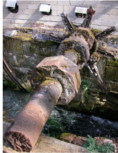
Vestiges de l'arbre principal de la roue hydraulique.
