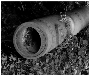
Détail de la chaudière portant l'inscription du constructeur Joesph Farcot St Ouen Seine. Phot. Thierry Lefébure IVR22_20006000583X
