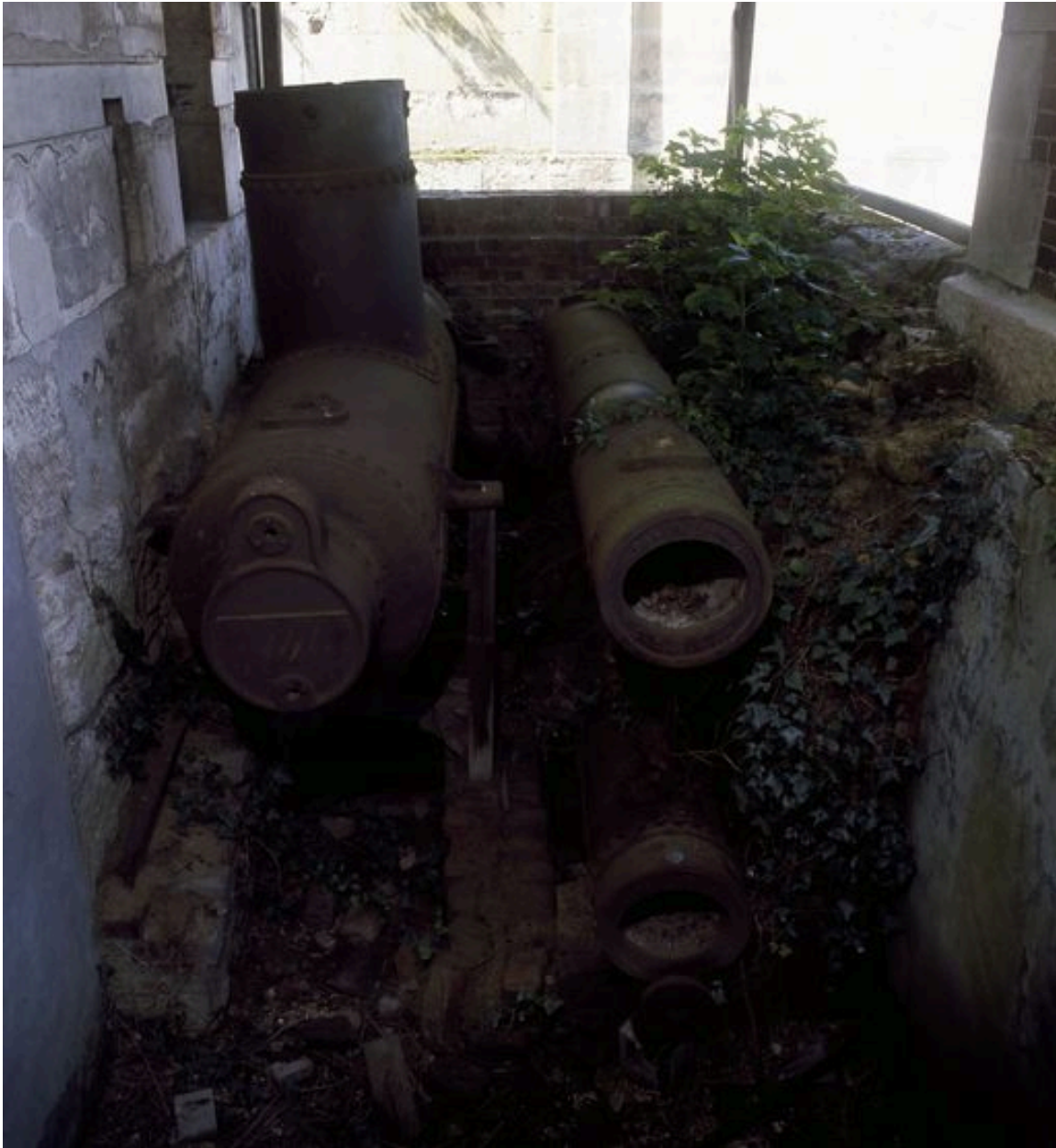
Chaudière tubulaire à deux bouilleurs.
