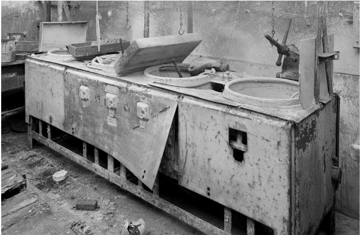
L'atelier de fabrication reconstruit après la guerre, banc de polissage.
