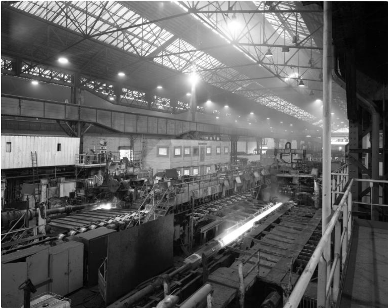
Salle des laminaires (usine C). Vue générale de l'élongateur. Le tube vient d'être percé et va être étiré.
