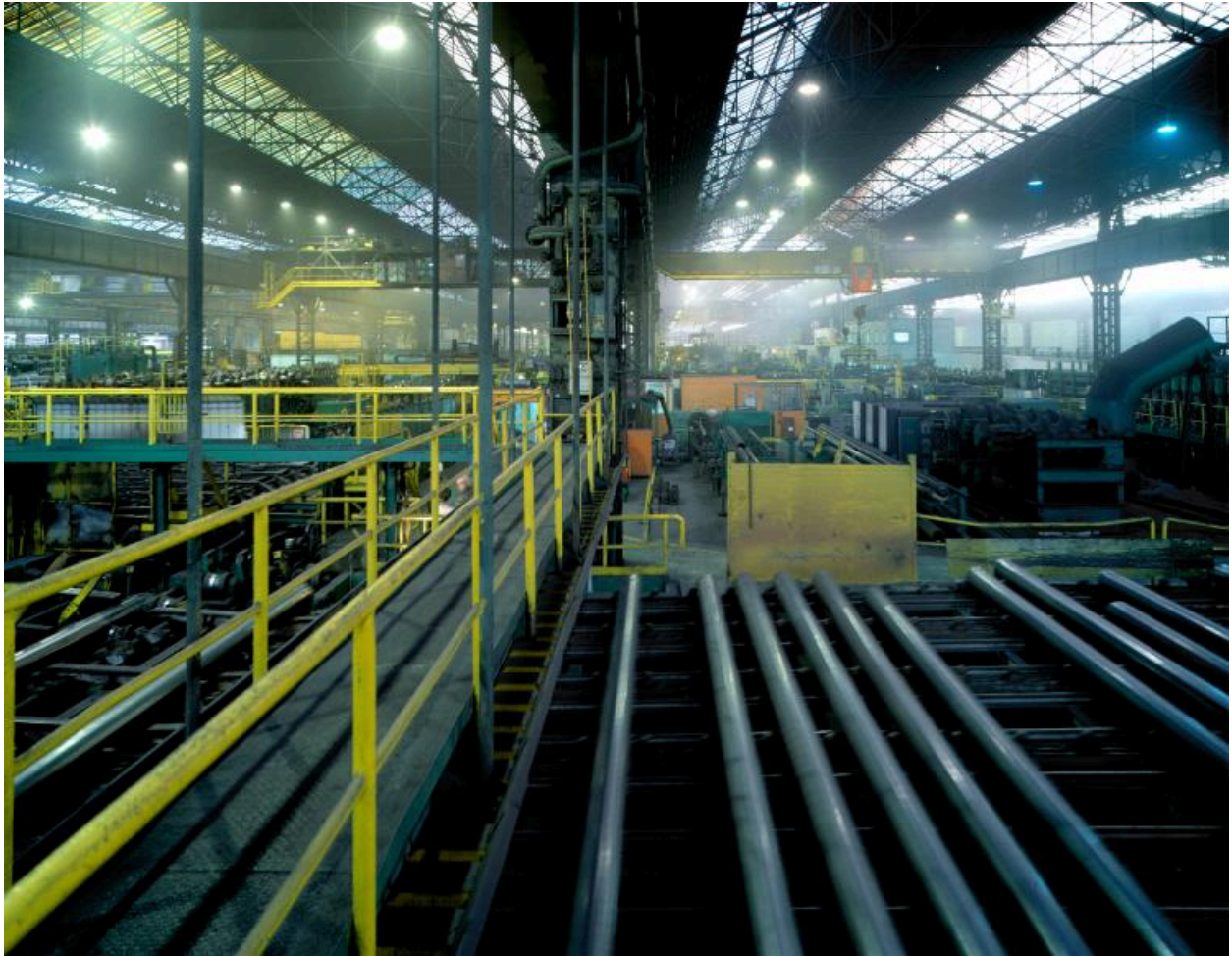
Les laminoirs (usine C). Vue générale de toute la chaîne. Le traitement thermique au premier plan.
