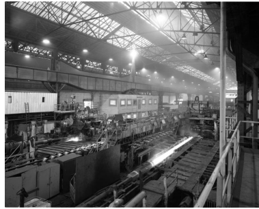
Salle des laminaires (usine C). Vue générale de l'élongateur. Le tube vient d'être percé et va être étiré. Phot. Thierry Petitberghien IVR31_20025900340V
