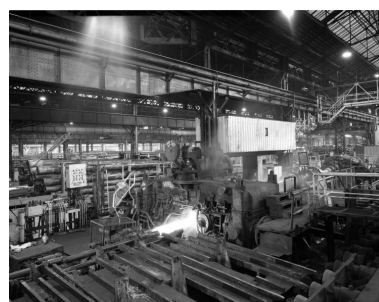
Les laminoirs (usine C). Vue générale du perceur Meer-Mannesmann AG, datant des années 1930. Au premier plan, le tube en cours de perçage.
