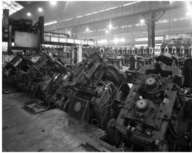
Salle des laminaires (Usine C). Vue générale des calibreurs. Phot. Thierry Petitberghien IVR31_20025900342V
