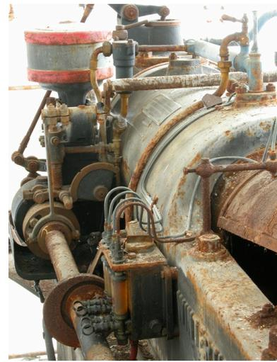
Au premier plan, l'arbre de distribution et le graisseur du moteur.
