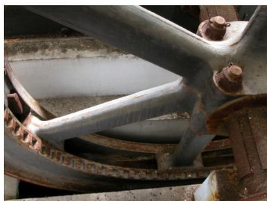
Le volant de la machine : détail.
