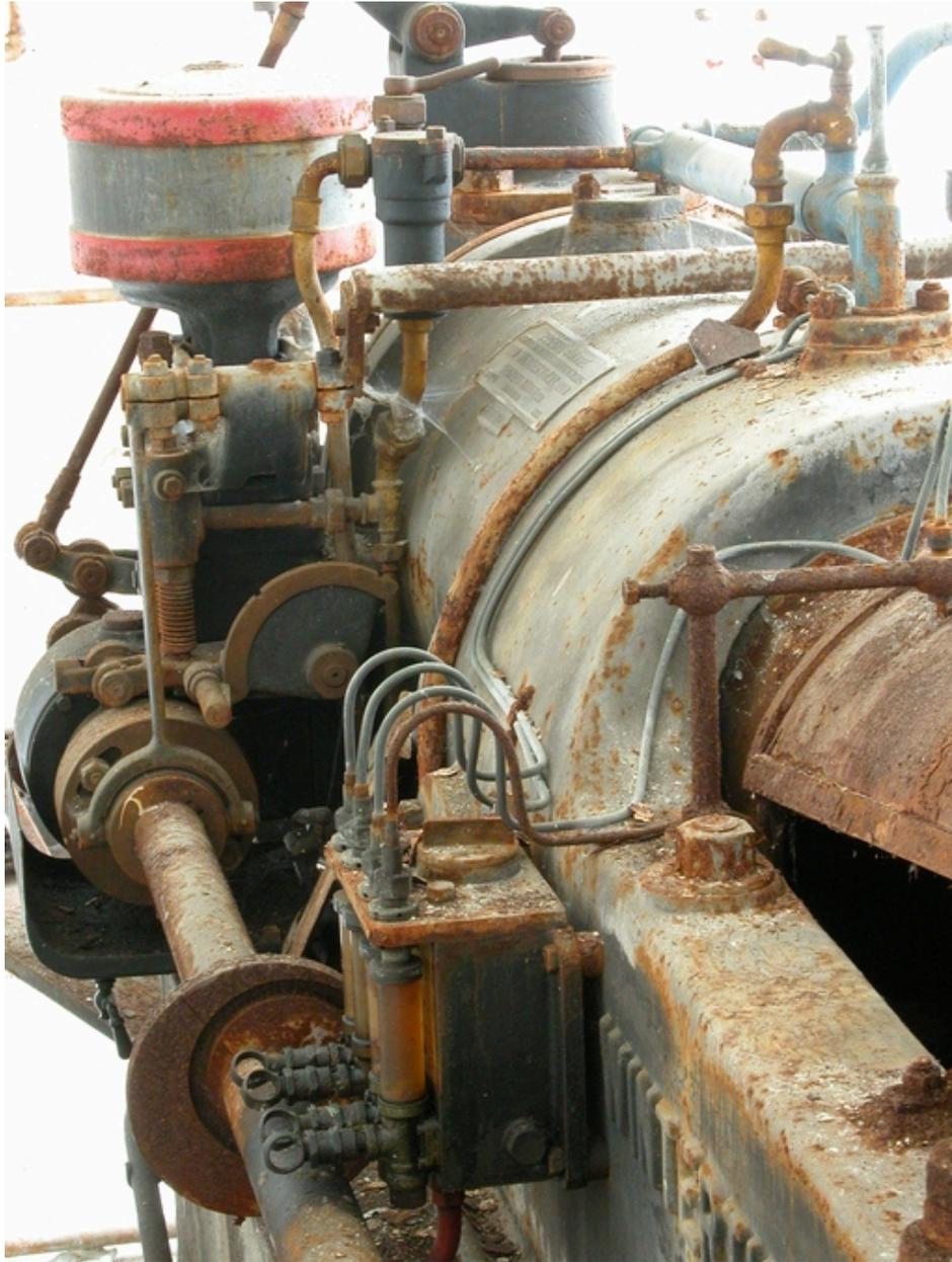
Au premier plan, l'arbre de distribution et le graisseur du moteur. A l'arrière plan, le régulateur et le système d'admission des gaz.
