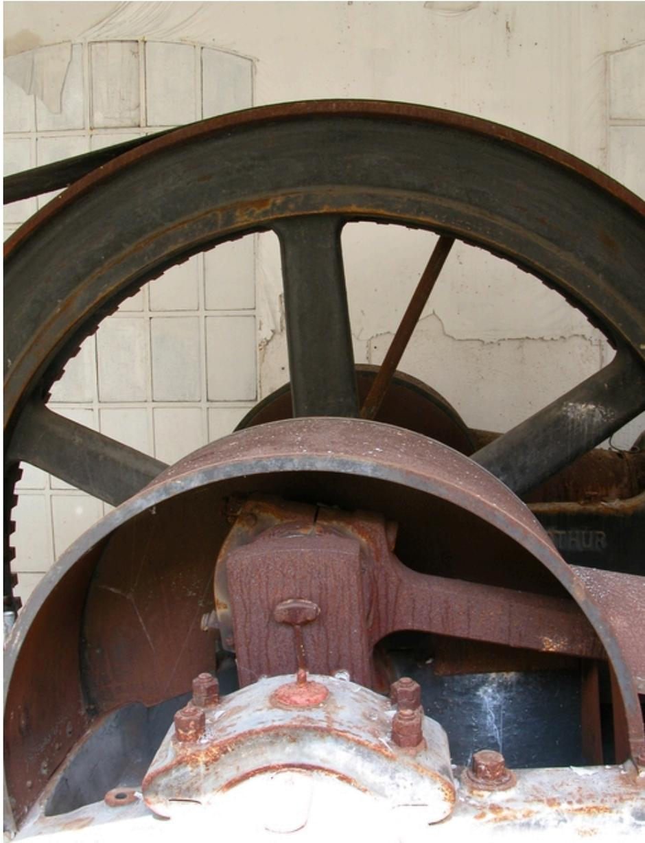
Axe du volant, arbre de transmission et bielle de l'un des deux moteurs.
