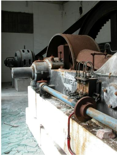
Arbre de transmission, système de graissage (tubes en verre brisés), bâti de l'un des deux moteurs contenant son arbre de transmission, et axe du volant.
