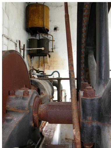
De droite à gauche : le volant, son axe et l'un des deux paliers, intégré au bâti de l'un des moteurs. A l'arrière-
