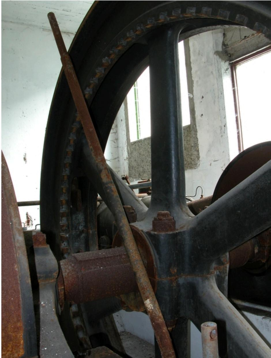
Volant de la machine à gaz.
