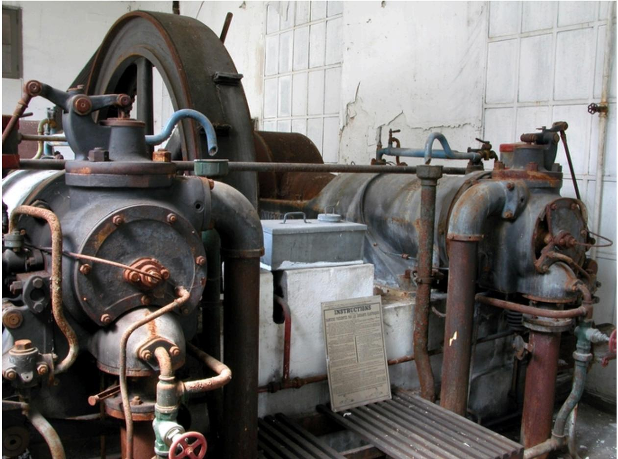
Les deux moteurs et le volant de la machine à gaz.
