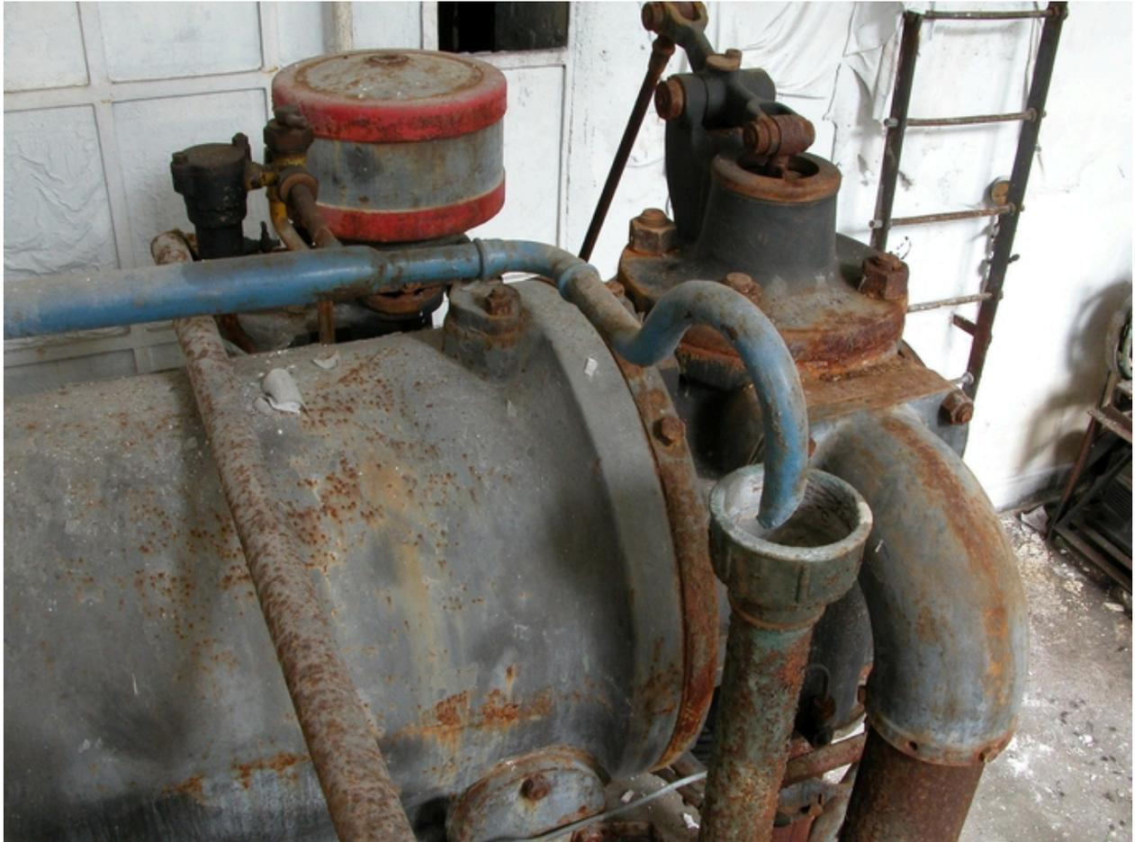
Régulateur, système d'admission et échappement des gaz de l'un des deux moteurs.
