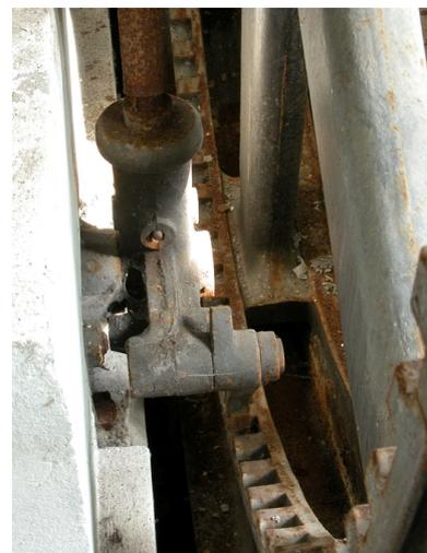
Mécanisme manuel de blocage du volant.
