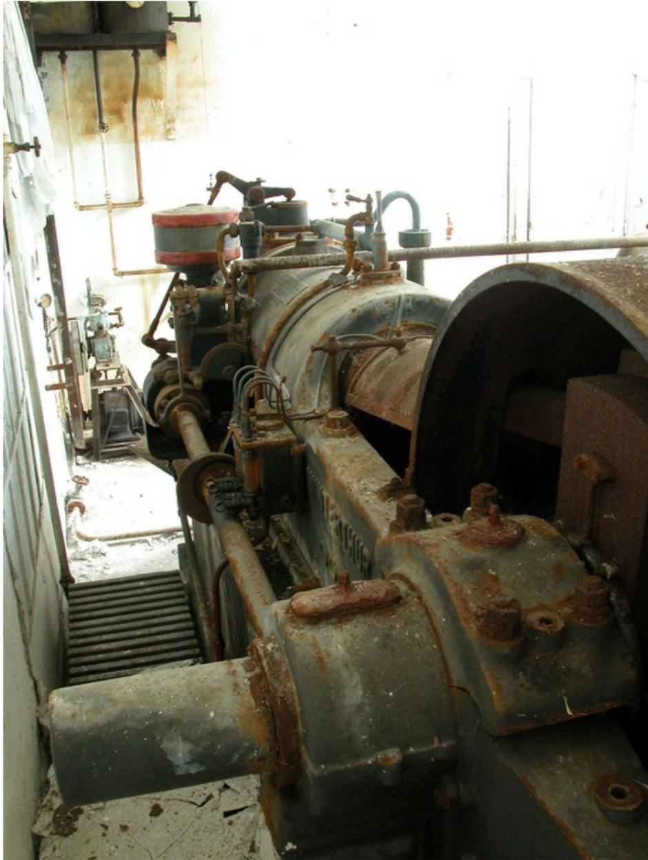
L'un des deux moteurs de la machine : au premier plan, l'axe du volant.
