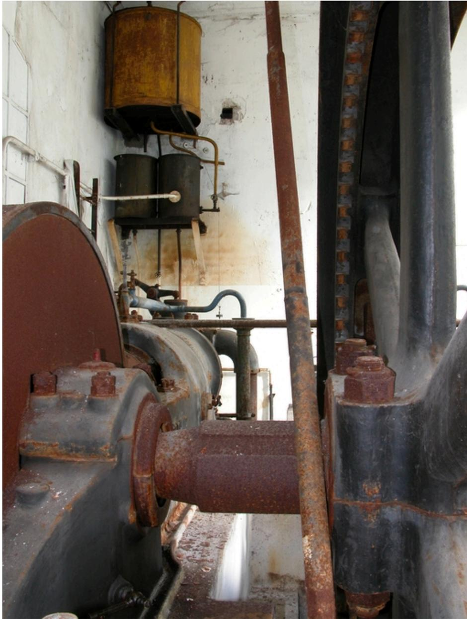
De droite à gauche : le volant, son axe et l'un des deux paliers, intégré au bâti de l'un des moteurs. A l'arrière-plan, en eau, les bacs d'eau pour le refroidissement des moteurs.
