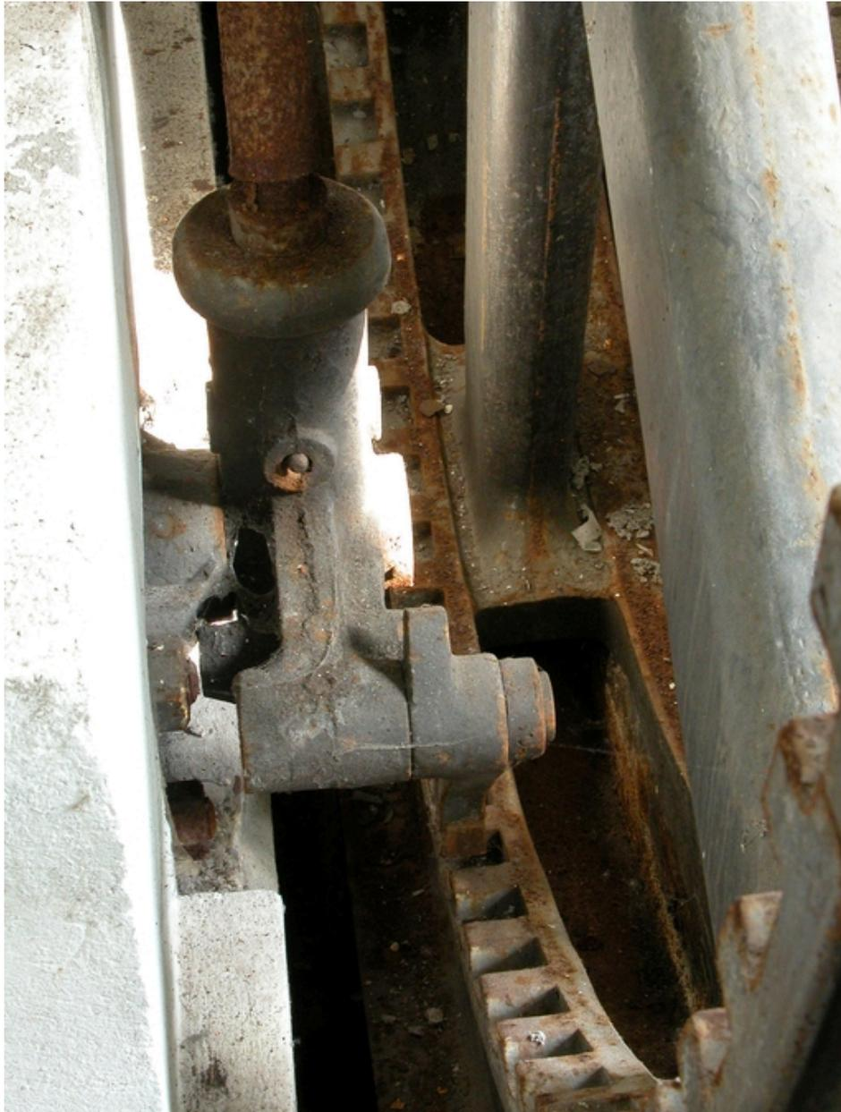
Mécanisme manuel de blocage du volant.
