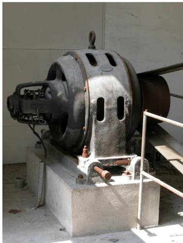
Générateur composé d'une dynamo et d'un alternateur du constructeur Schneider & Cie.
