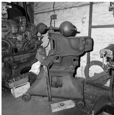
Atelier de fabrication, étampeuse (sans marque). Les deux boules métalliques sont destinées à accroître l'énergie cinétique du volant. Phot. Philippe Dapvril IVR31_19885900808X
