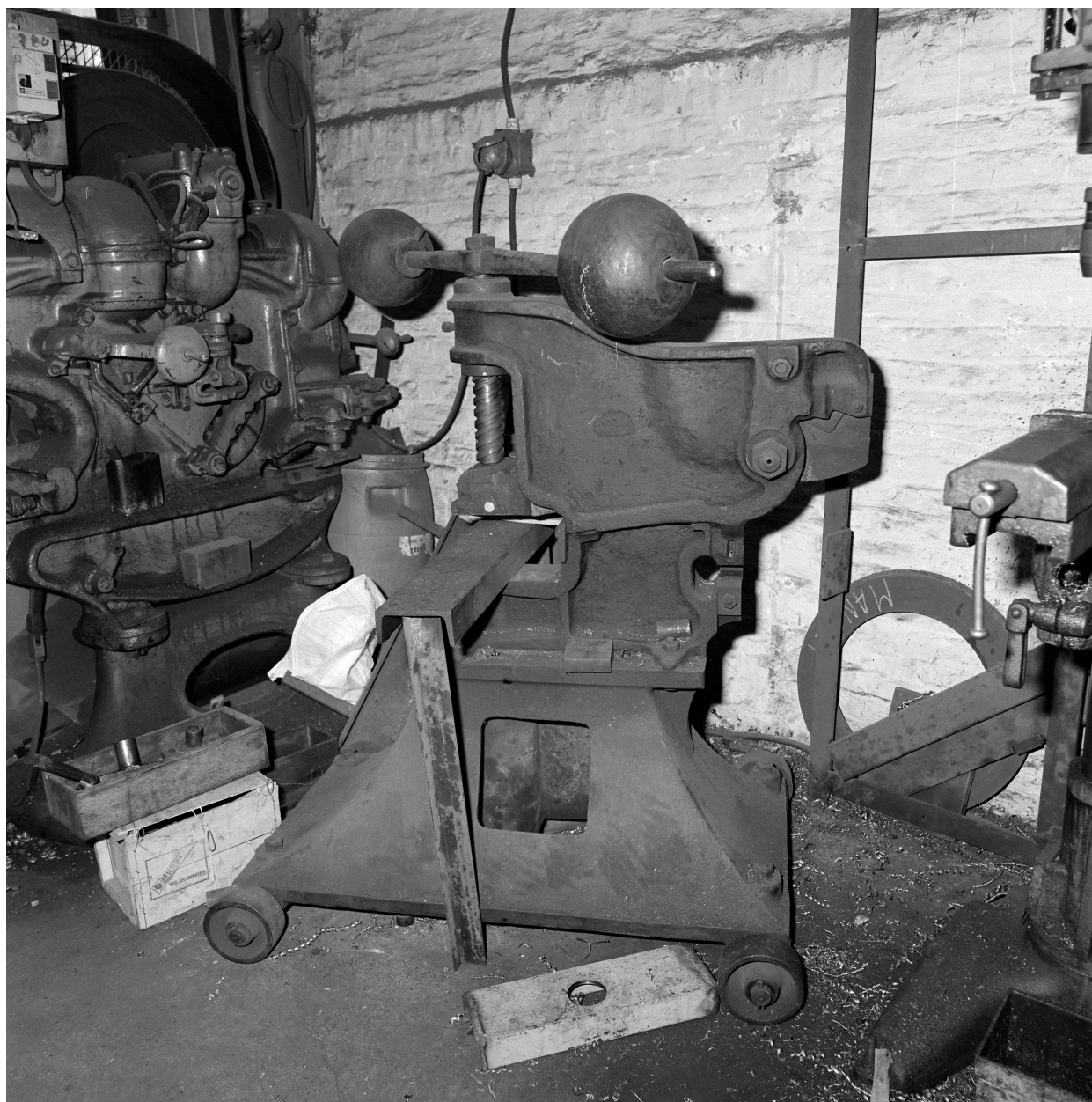
Atelier de fabrication, étampeuse (sans marque). Les deux boules métalliques sont destinées à accroître l'énergie cinétique du volant.
