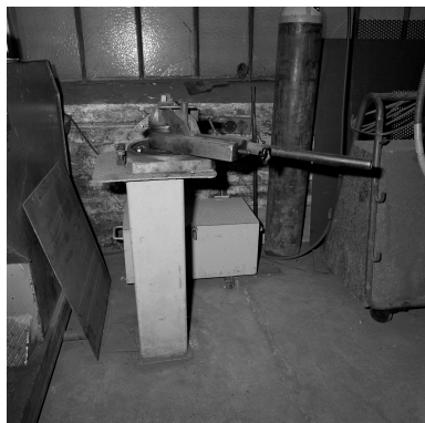
Atelier de fabrication, cintreuse à tube (sans marque). Phot. Philippe Dapvril IVR31_19885900812X
