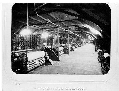
Atelier de tissage des établissements Pouchain : les ourdissoirs. Photographie, [ca 1897] (coll. part. Delepoulle). Repro. Olivier Marlard, Phot. auteur inconnu IVR31_19885902182X
