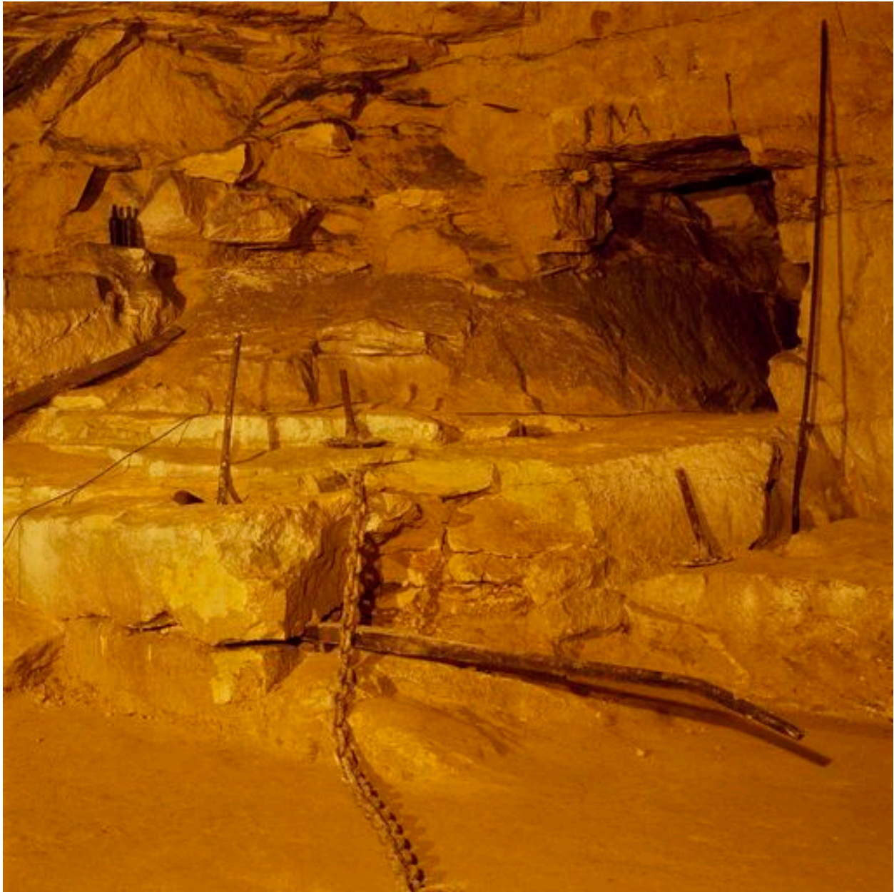
Chantier de taille et ses outils : aiguille, barre à loper, treuil et scie.
