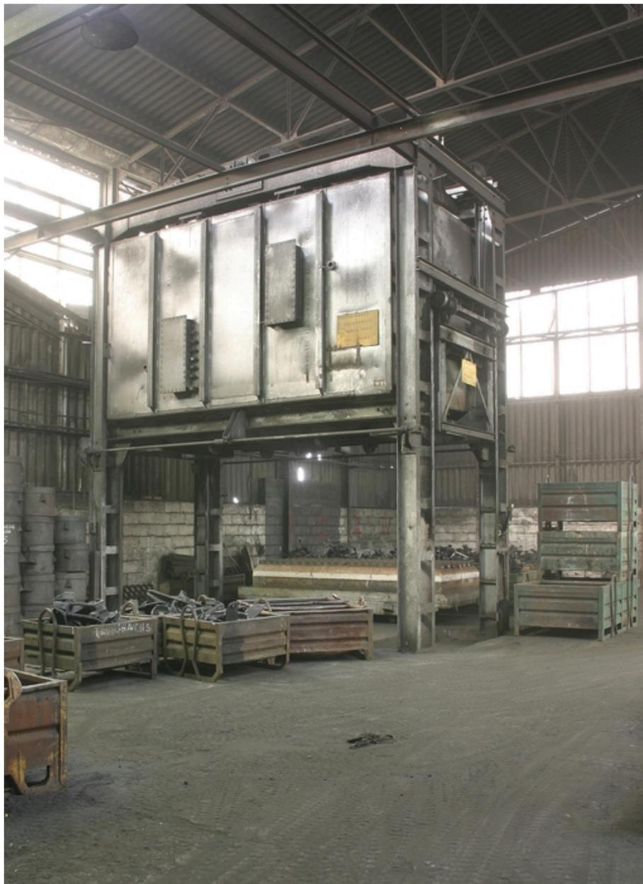
Four électrique de traitement thermique à sole mobile.
