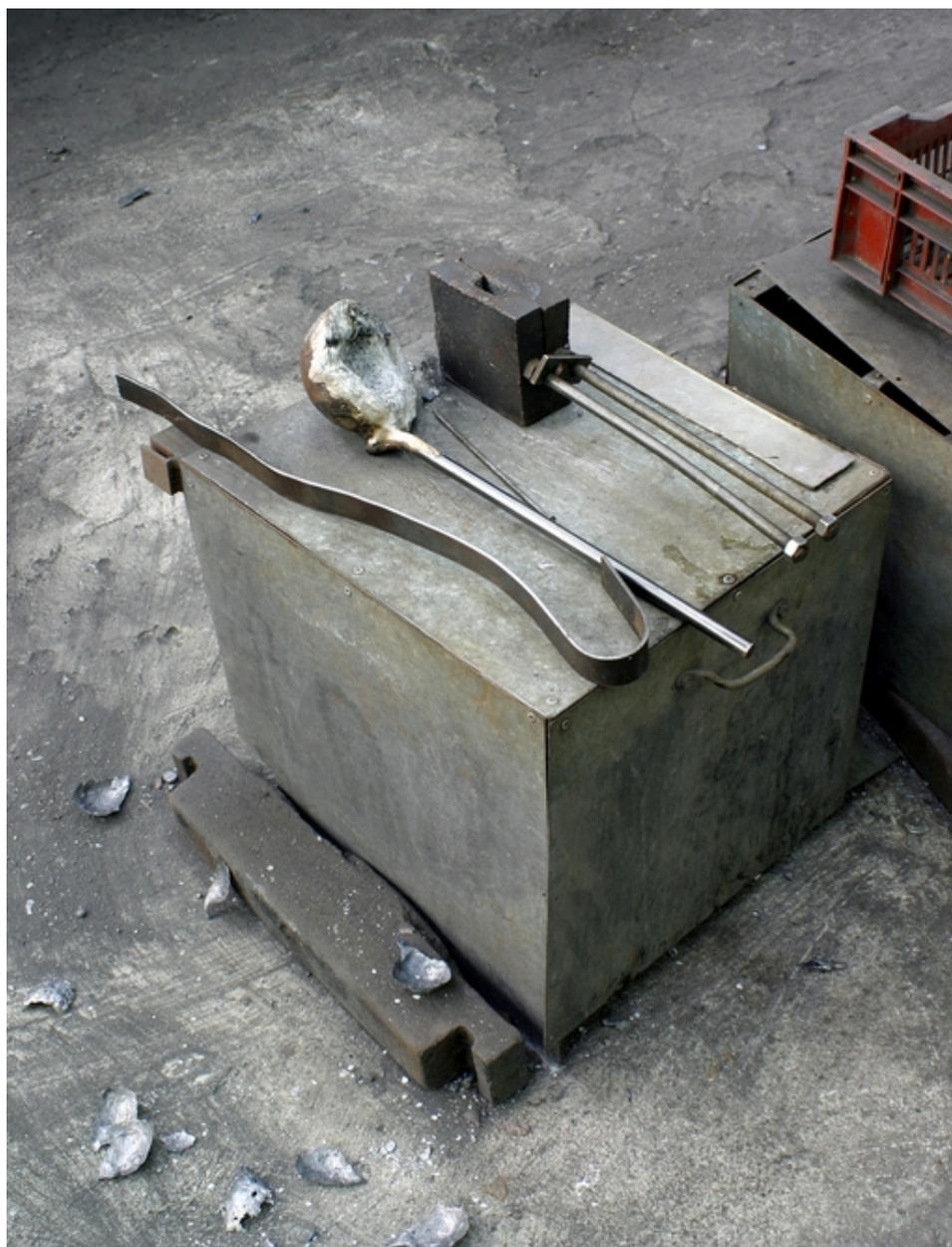
Outils pour prélever des échantillons de fonte à des fins d'analyses et d'essais.
