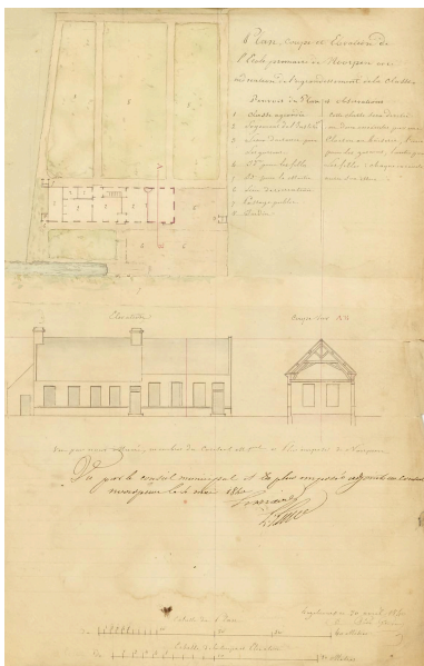
Plan, coupes et élévations de l'école primaire de Noordpeene avec mention d'agrandissement de la classe, dressé par Gesse Gervais, architecte départemental, le 20 avril 1840 (AD Nord : 2 O 437 / 23). Repro. Delphine Volto Jourdan IVR32_20255900561NUCA
