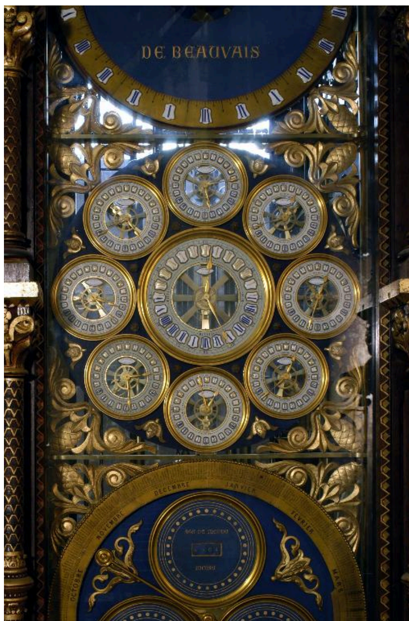
Vue de détail des cadrans dans la partie centrale de la baie de droite : l'heure moyenne civile du méridien de Rome et de 8 villes à l'Est de Paris.
