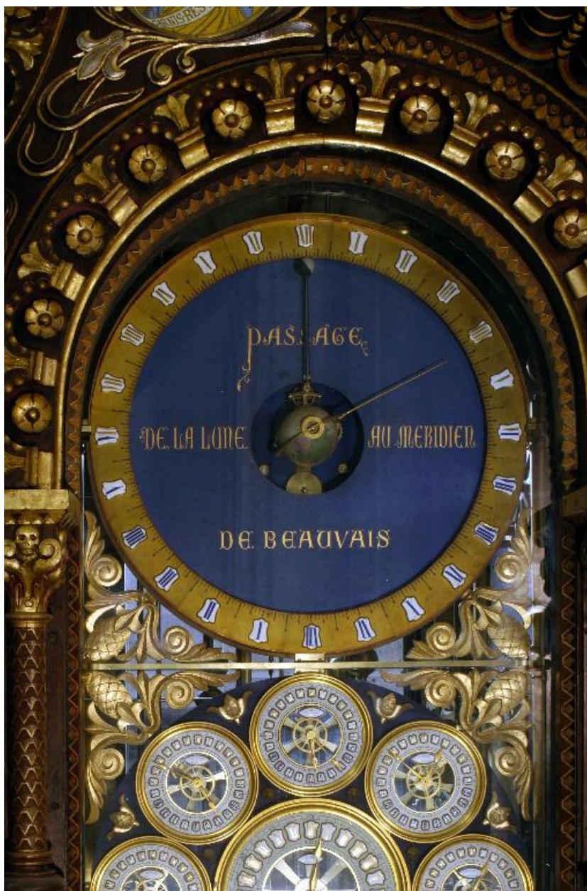
Vue de détail des cadrans dans la partie supérieure de la baie de droite : les phases de la lune et l'heure de son passage à Beauvais.
