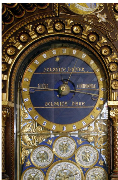
Vue de détail du cadran situé dans la partie supérieure de la baie gauche : heures du lever et du coucher du soleil à Beauvais.
