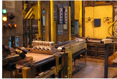
Denoyautage : la pièce vient d'être séparée de son noyau en silice.
