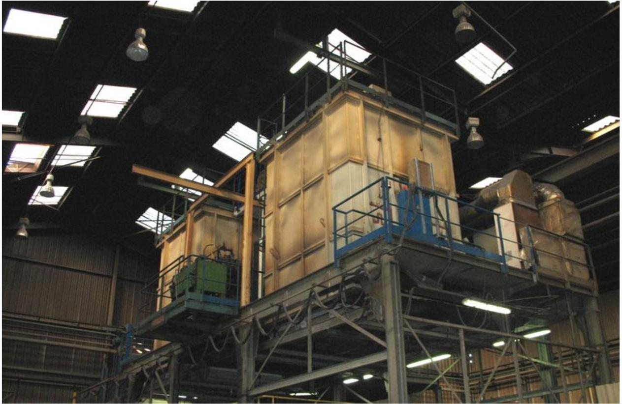
Le traitement thermique des pièces, opération réalisée dans deux fours automatiques, dure 11 heures.
