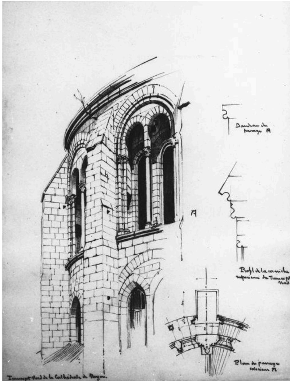
Bras nord du transept. Détail de l'élévation, plan et profil, par Trouvelot, 1920.
