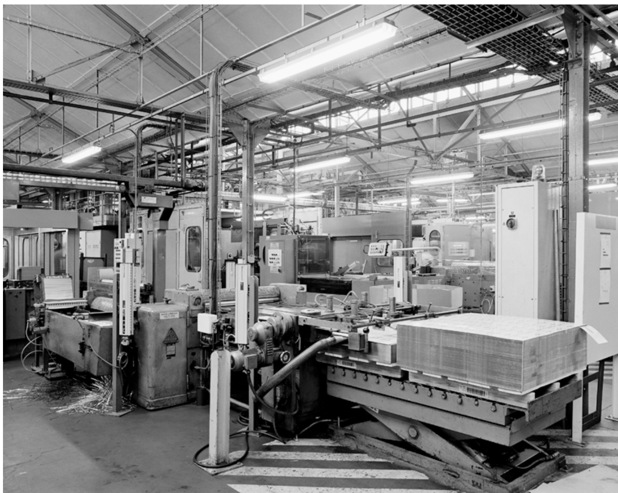
Intérieur de la ferblanterie : début de la chaîne de façonnage des boîtes en métal, à partir de plaques de métal imprimées.
