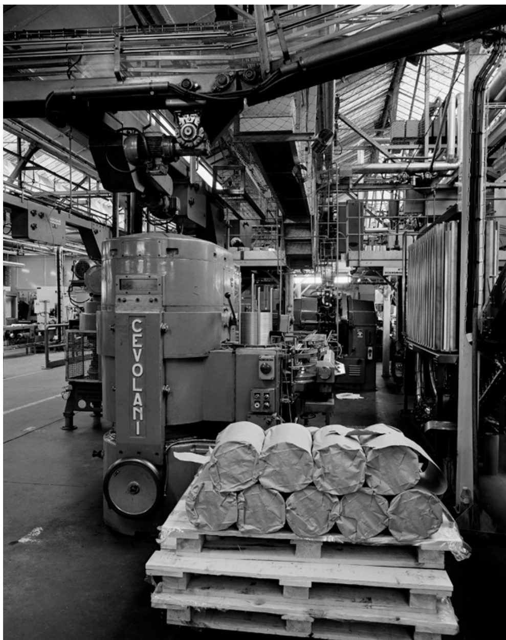
Vue intérieure partielle de la ferblanterie où sont fabriquées les boîtes de métal destinées à contenir le lait en poudre.
