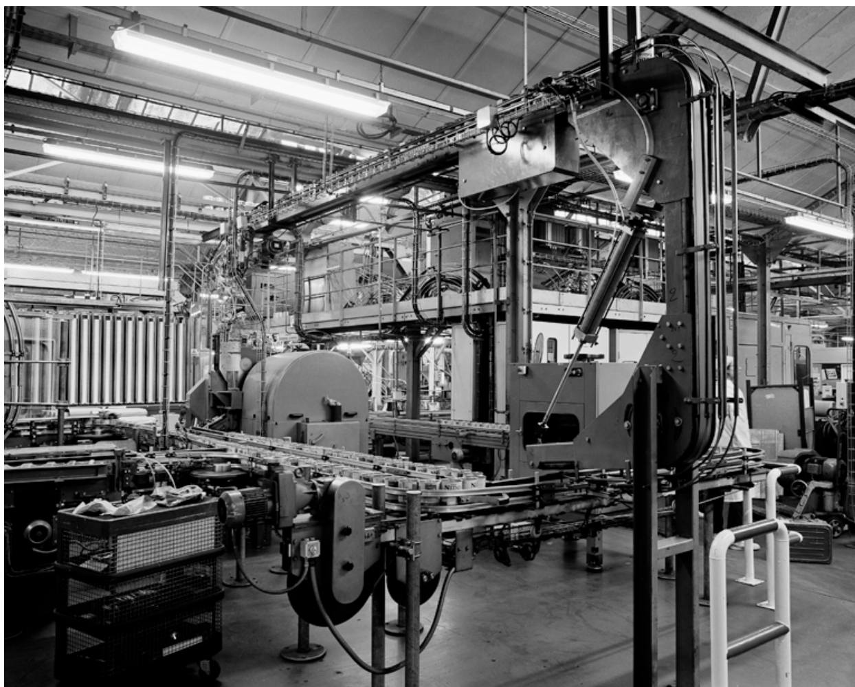
Vue intérieure partielle de la ferblanterie : fabrication des boîtes en métal destinées à contenir le lait en poudre.
