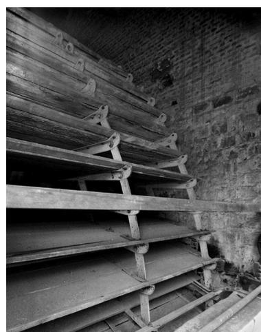
Détail de la roue hydraulique verticale
