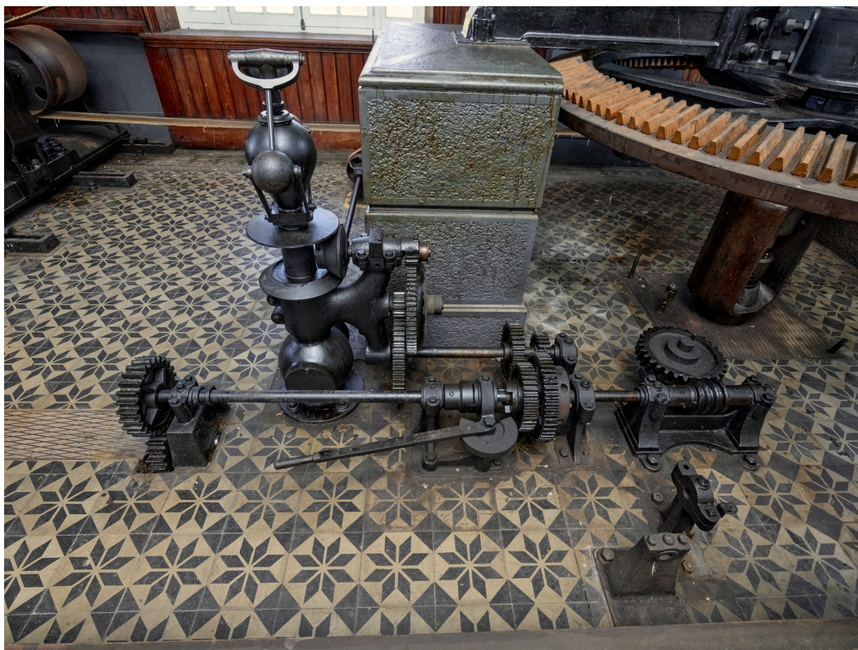
Intérieur, régulateur à boules.
