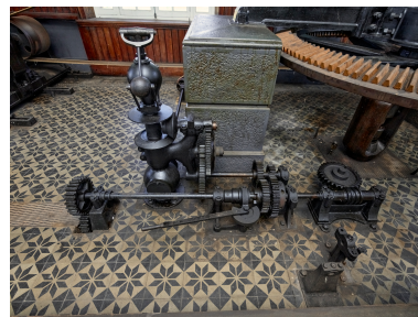
Intérieur, régulateur à boules. Phot. Thierry Lefébure IVR32_20258000573NUCA
