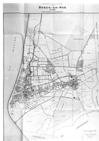
Plan topographique de la commune de Berck, dressé vers 1928, constituant un avant-projet d'aménagement visant à améliorer la voirie par rectification du tracé de certaines rues et routes existantes et par l'ouverture de nouvelles voies. Phot. Pierre Thibaut IVR31_20056200138V
