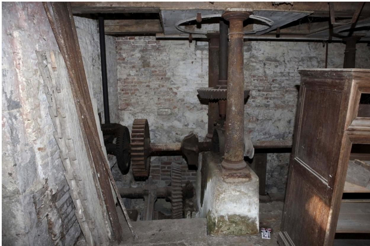
Vue de l'arbre moteur et des embrayages coniques (endommagés).
