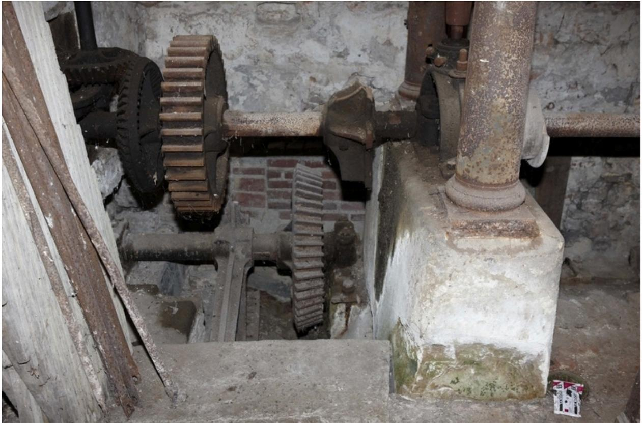
Détail de l'arbre moteur et des embrayages coniques (endommagés).
