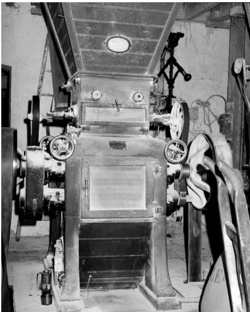
Vue intérieure du moulin, 1er étage : machine à broyer.
