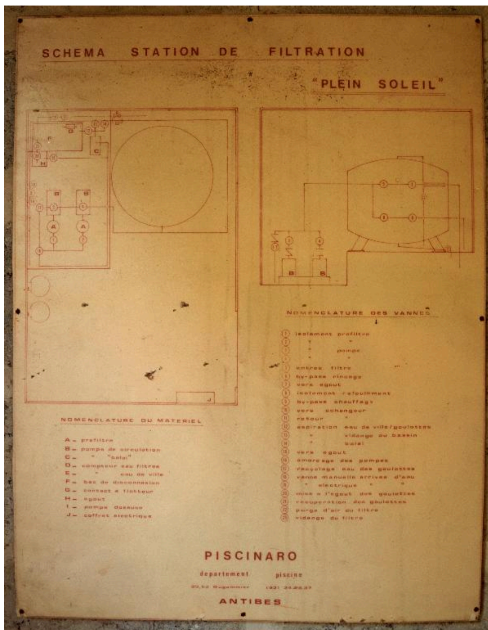
Panneau représentant un schéma de fonctionnement dy système de filtration de la piscine "Plein Soleil", accroché dans le local technique.
