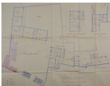
Ville du Quesnoy - école de filles : construction d'un préau en béton armé, de WC et d'un abri à bicyclettes : plan du rez-de-chaussée projeté. Dessin de l'architecte (non signé), daté de février 1938 (AD Nord, 20345-312).
