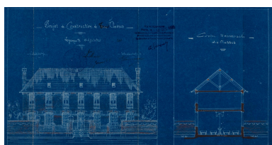
École de filles - construction de trois classes avec logements : logement des adjointes, coupe transversale des classes. Dessin signé d'Edmond Lemaire, architecte, daté de septembre 1904 (AD Nord, 20345-109). Repro. Pierre Thibaut IVR32_20255901441NUCA
