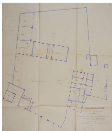
Ville du Quesnoy - école de filles : construction d'un préau en béton armé, de WC et d'un abri à bicyclettes : plan actuel du rez-de-chaussée. Dessin de l'architecte (non signé), daté de février 1938 (AD Nord, 20345-312).
