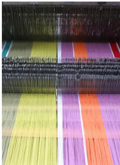
Machine à tisser à lances et ratière. Casse-chaînes et lames de lisses à l'arrêt.
