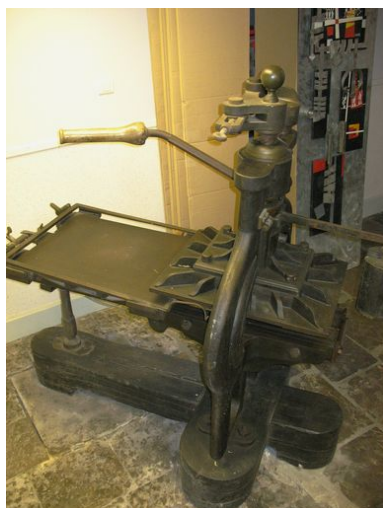
Machine typographique de type Stanhope : vue arrière. Phot. Maya Bennani IVR31_20106203899NUCA
