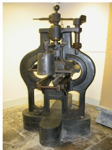
Presse typographique de type Stanhope, vue de trois quarts. Phot. Maya Bennani IVR31_20106203898NUCA
