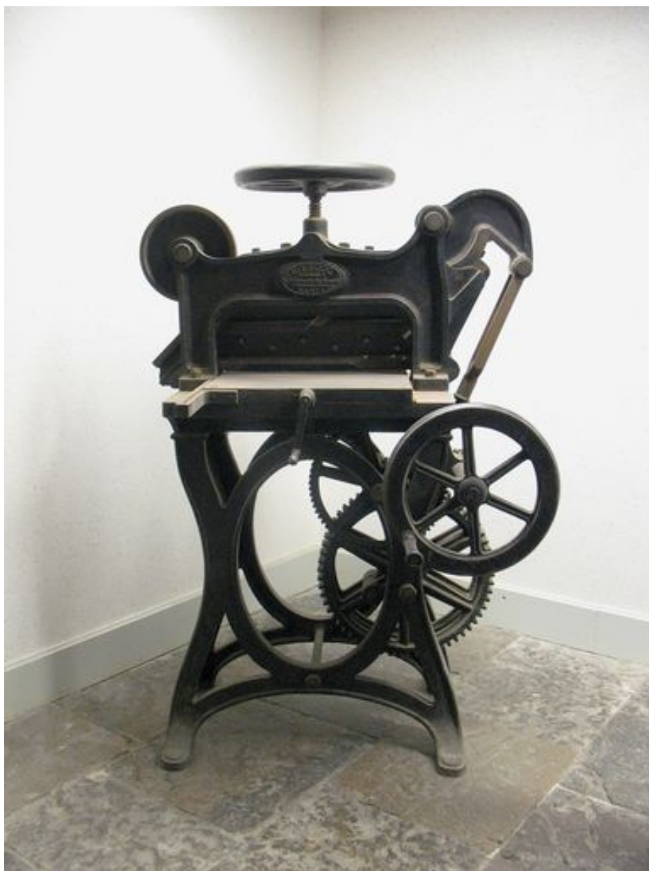
Machine d'imprimerie de type massicot, vue générale.
