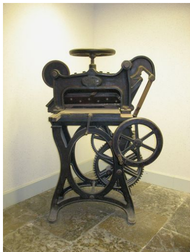
Machine d'imprimerie de type massicot, vue de côté. Phot. Maya Bennani IVR31_20106203902NUCA
