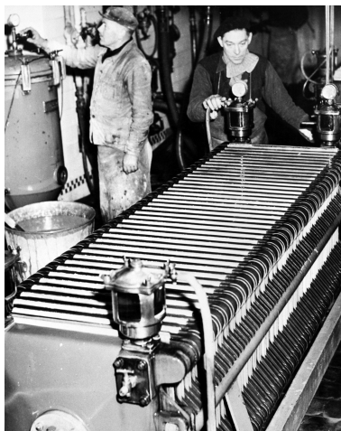
Filtre Kieselguhr (ou à terre diatomée) : filtration finale avant conditionnement, 1954 (AP Coutances). Repro. Thierry Petitberghien IVR31_19915900543XB
