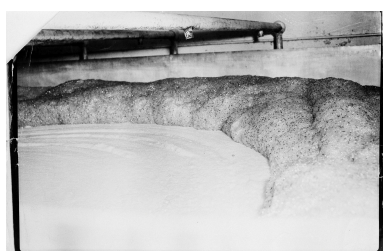
Opération de fermentation, cuves ouvertes dites guilloires, après 1945 (AP Coutances). Repro. Thierry Petitberghien IVR31_19915900516XB
