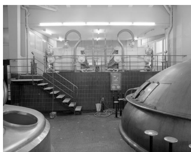
Salle de brassage ; au fond, filtre à moût. Phot. Thierry Petitberghien IVR31_19915900559X
