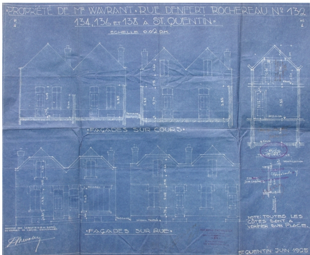
Elévations et coupes des logements sur rue, par R. Chevallier, 1925 (AC Saint-Quentin).
