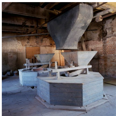
Intérieur du premier étage, vue des deux meules sous leur coffrage. Phot. Bertrand Fournier IVR22_20026001051XA
