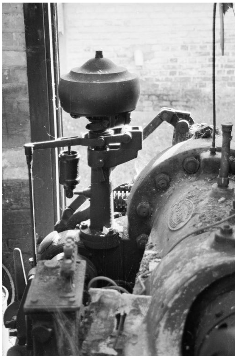
Moteur à pistons à combustion (machine à pression d'huile) : détail du régulateur.
