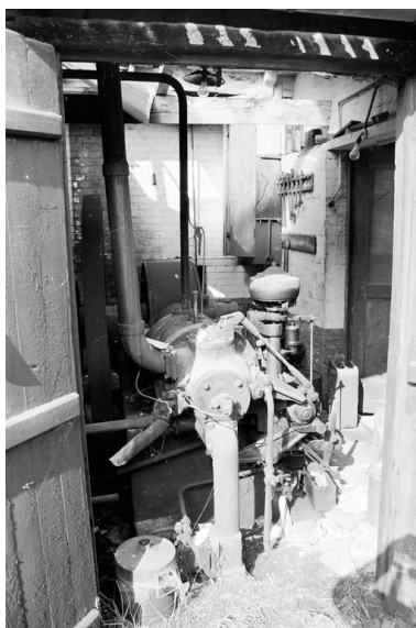
Moteur à pistons à combustion (machine à pression d'huile) : vue de face. Phot. Bertrand Fournier IVR22_20006000692Z
