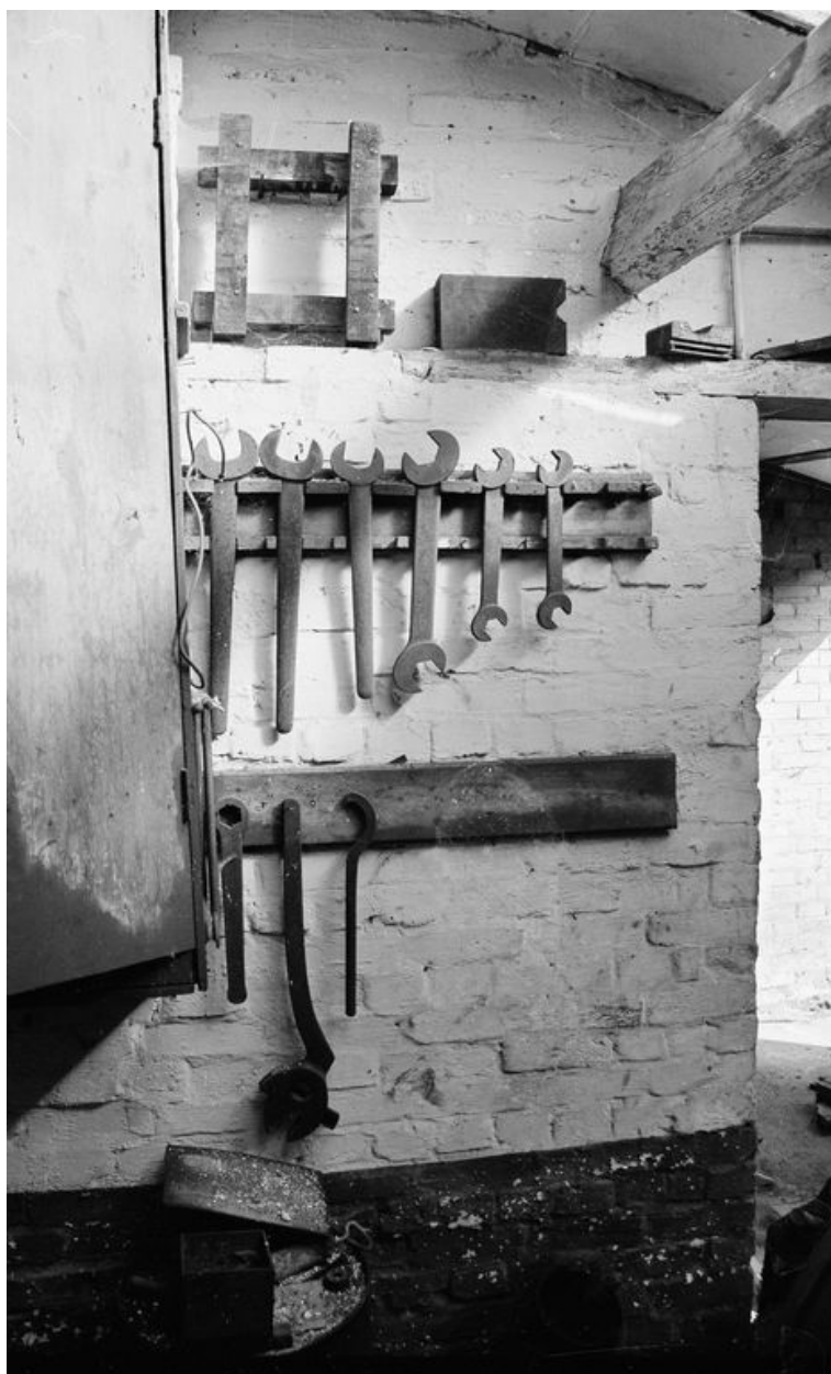
Intérieur de la chaufferie : détail des outils nécessaires à l'entretien de la machine à pression à huile lourde.
