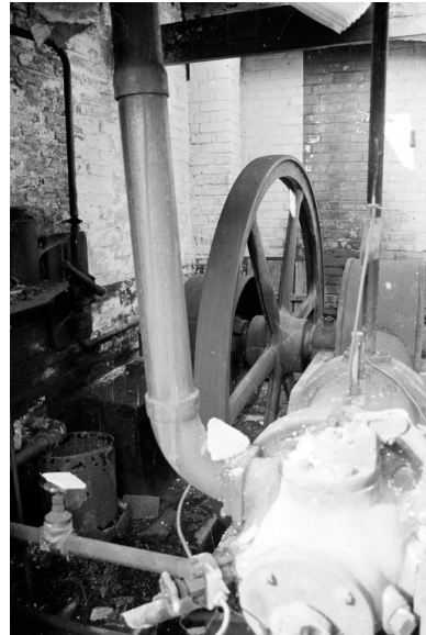
Moteur à pistons à combustion (machine à pression d'huile) : détail du volant de transmission. Phot. Bertrand Fournier IVR22_20006000693Z
