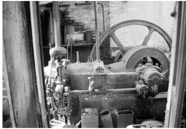
Moteur à pistons à combustion (machine à pression d'huile) : vue de profil. Phot. Bertrand Fournier IVR22_20006000696Z
