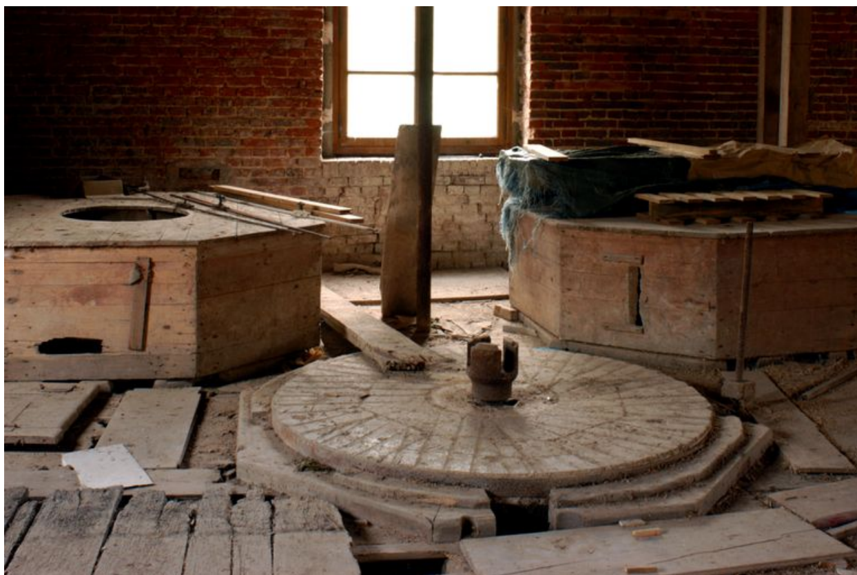
Intérieur du premier étage, détail des trois paires de meules.
