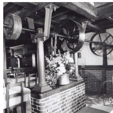
Intérieur, arbre horizontal et les poulies de transmission. Phot. Thierry Lefébure IVR22_20026000854X
