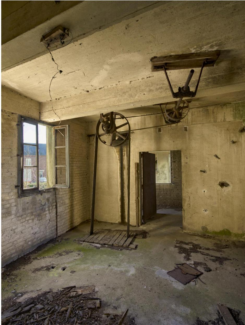
Arbre de transmission, poulies et courroies.
