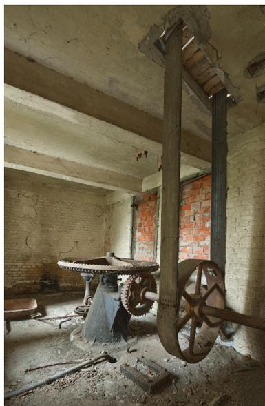
Turbine et sa courroie de transmission.
