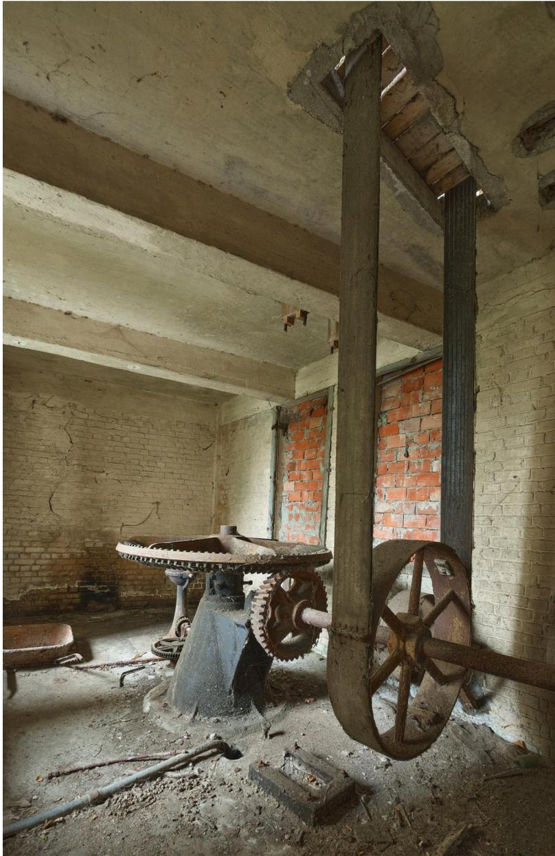
Turbine et sa courroie de transmission.
