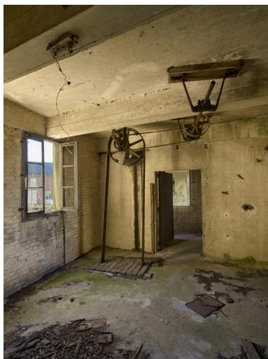
Arbre de transmission, poulies et courroies.
