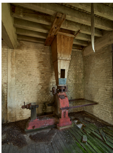
Trémie. Phot. Thierry Lefébure IVR32_20228000089NUCA
