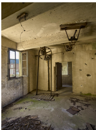
Arbre de transmission, poulies et courroies. Phot. Thierry Lefébure IVR32_20228000080NUCA
