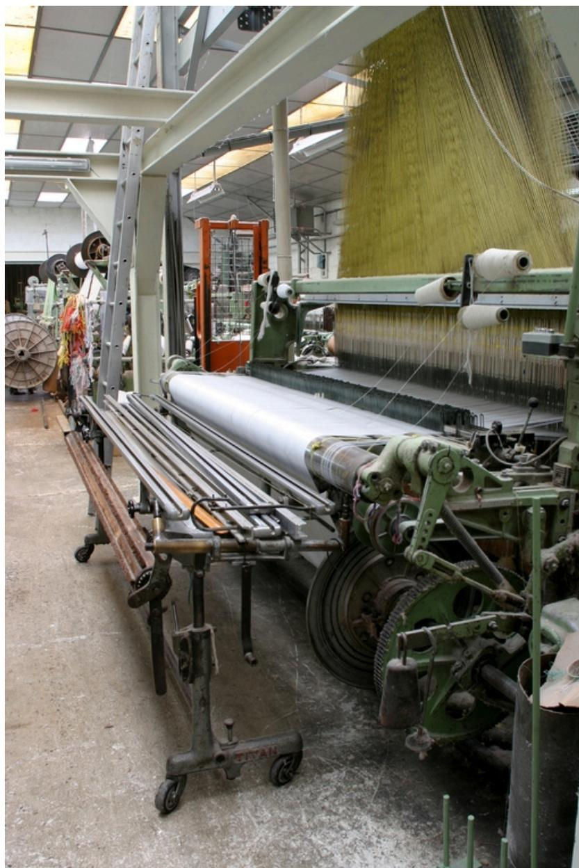
L'arrière de la machine à tisser : le porte-fils oriente les fils vers les lisses reliées par les arcades à la mécanique Jacquard.
