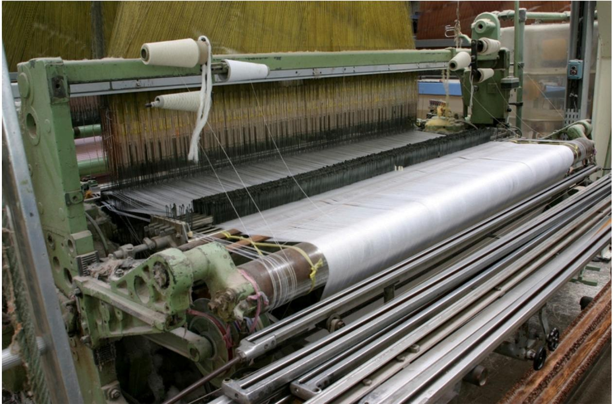
Parcours des fils de chaîne : le porte-fils, les barres d'encroix, les casse-fils et les lisses.
