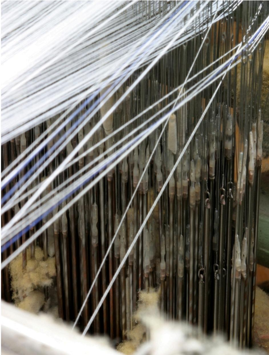
Les fils de chaîne passent dans les maillons des lisses reliées par leur extrémité inférieure à un mécanisme de rappel.
