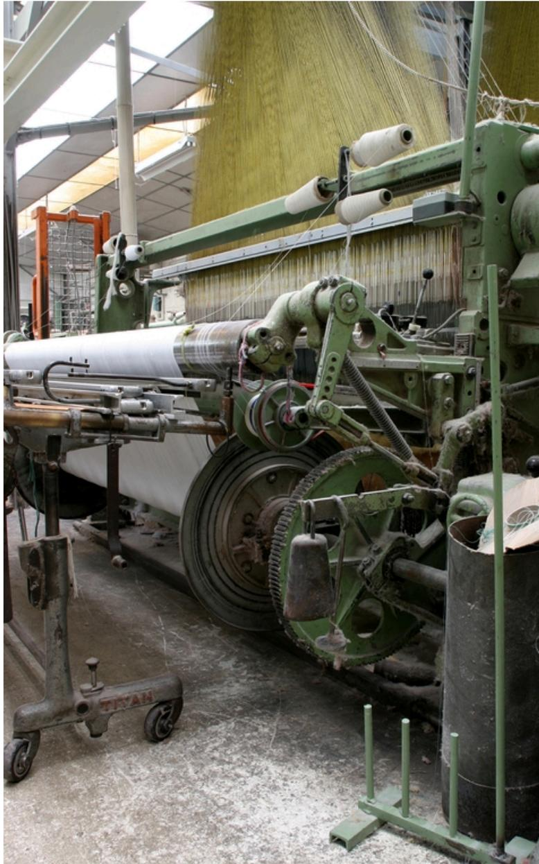
L'arrière de la machine à tisser : l'ensouple (en bas) déroule la chaîne en direction du porte-fils.
