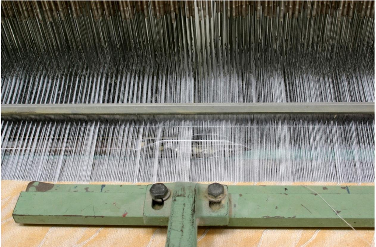
La lance d'entrée entraîne le fil de trame formant la duite (fil orange, perpendiculaire à la chaîne et parallèle au peigne) vers le centre du métier, où il sera repris par la lance de sortie. A l'arrière, les lisses.
