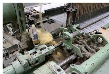
La lance d'entrée stopée en pleine action : on la distingue, dans la foule, entre le peigne et la ligne de façade (endroit de la frappe du peigne). On distingue bien l'action des lisses séparant la chaîne en deux nappes et formant la foule.
