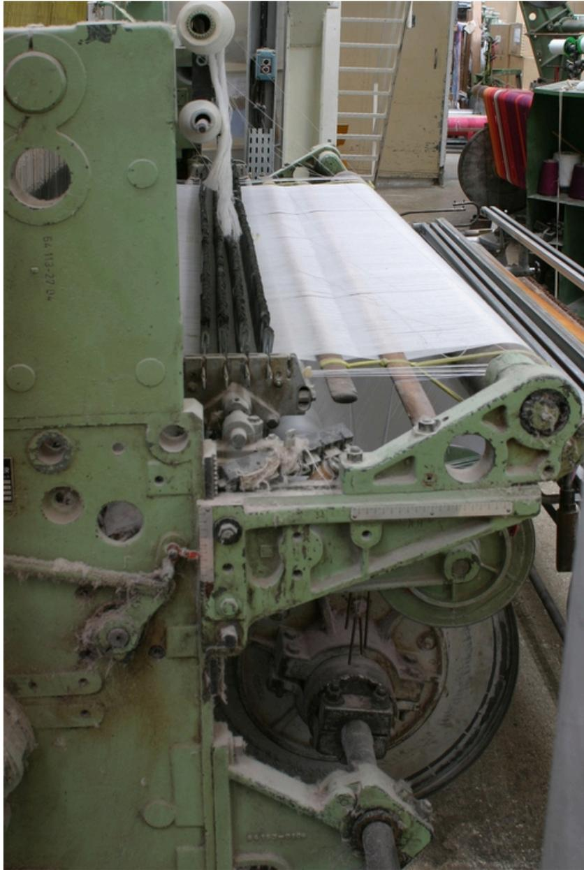
L'ensouple (en bas), surmontée des fils de chaîne traversés par les barres d'encroix et chevauchés par les casse-chaînes à lamelles.
