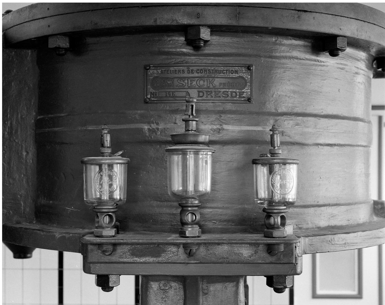
Pompe à vide à membrane. Atelier de construction Seck Frères (Dresde) : plaque de constructeur et graisseurs.
