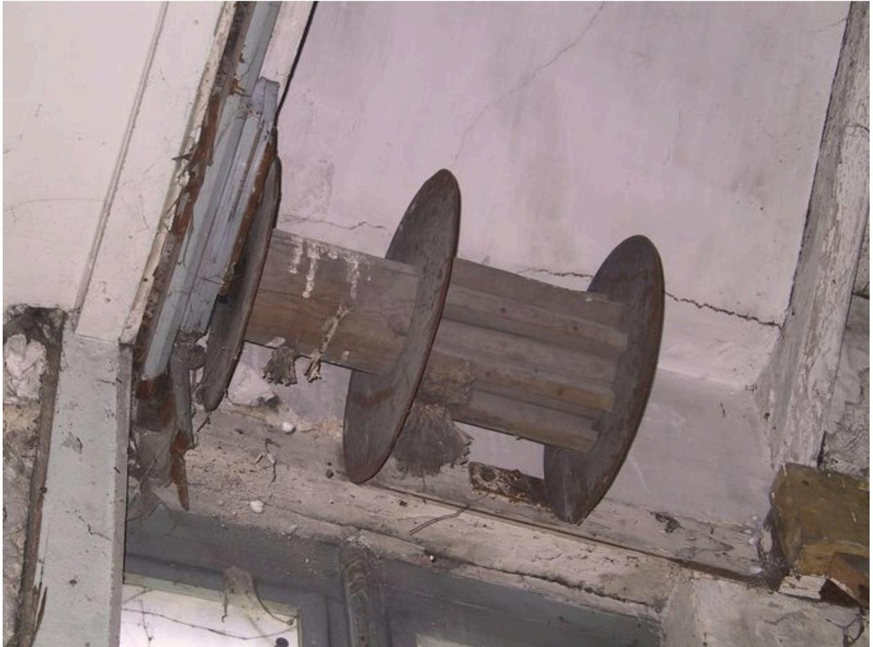
Intérieur, étage, salle de spectacle : treuil de machinerie, état en 2005.
