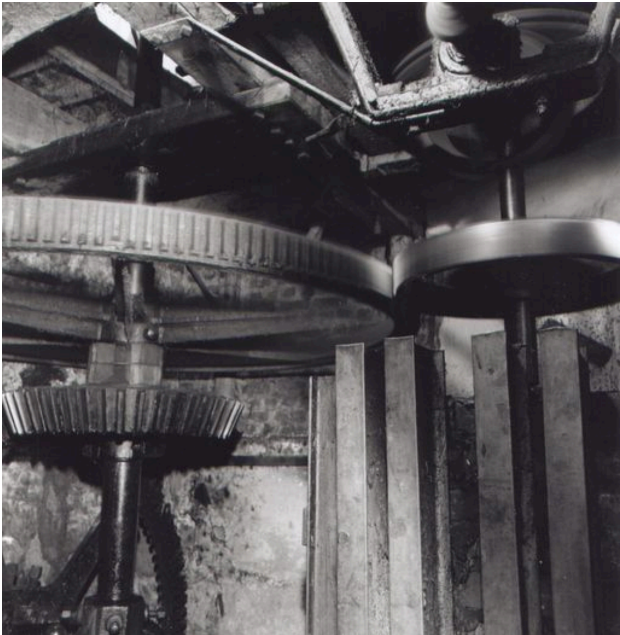
Détail des engrenages de transmission.
