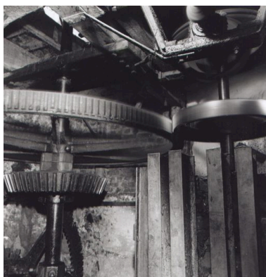
Détail des engrenages de transmission.
