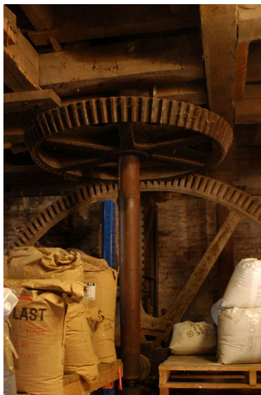
Détail du grand volant de transmission de la minoterie de 1858.
