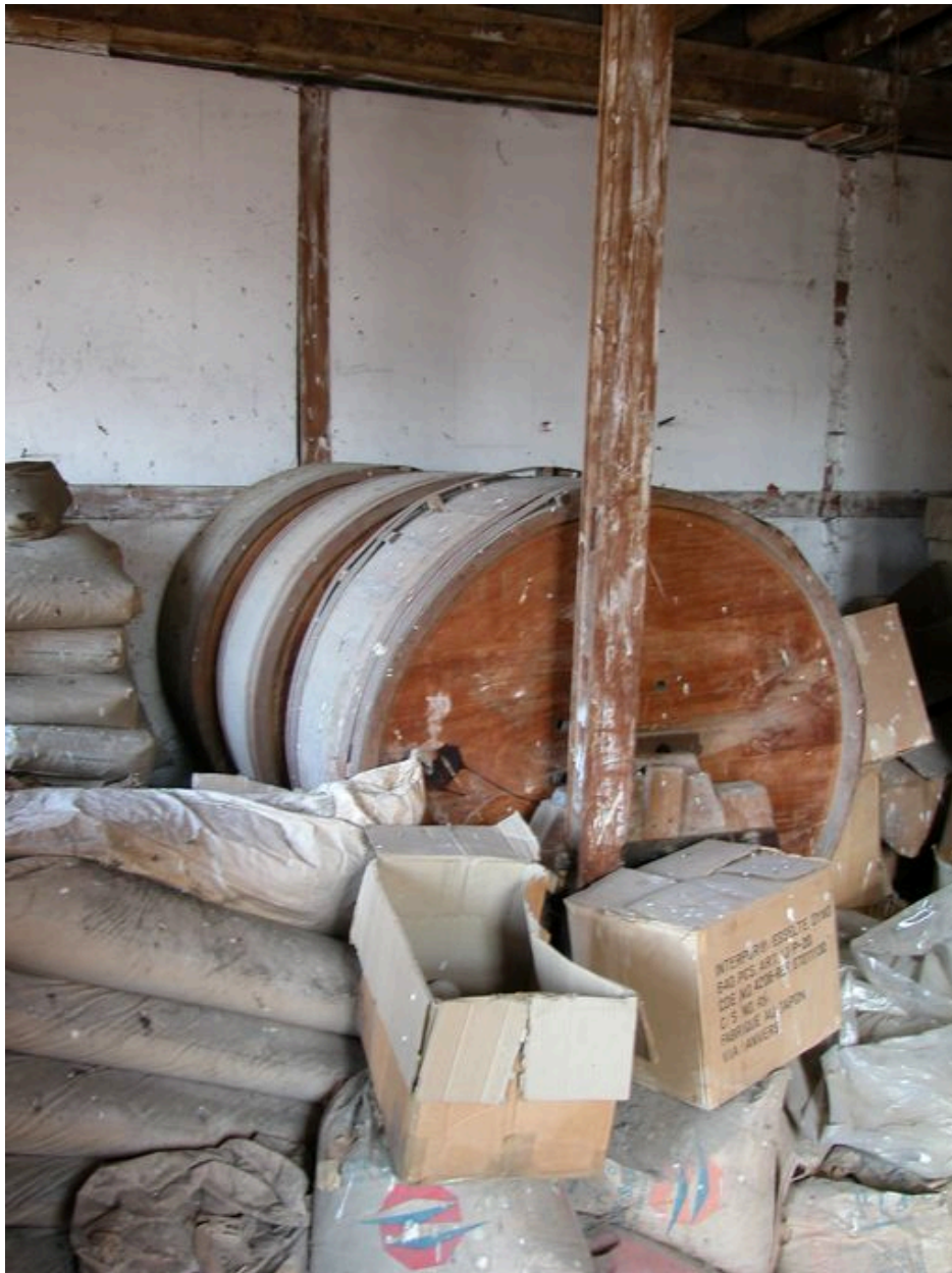
Intérieur du 2e étage de l'atelier de fabrication, détail des tonneaux de ponçage.
