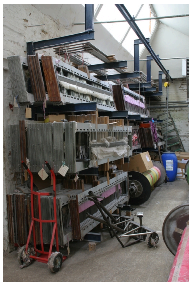
Stockage des cadres (ou lames) de lisses. Phot. Frédéric Pillet IVR22_20040201069NUCA
