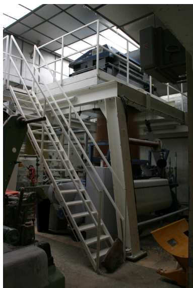
Machine à tisser à pincettes à commande numérique Sulzer Textil G6300, surmontée de sa mécanique Jacquard. Phot. Frédéric Pillet IVR22_20040201072NUCA
