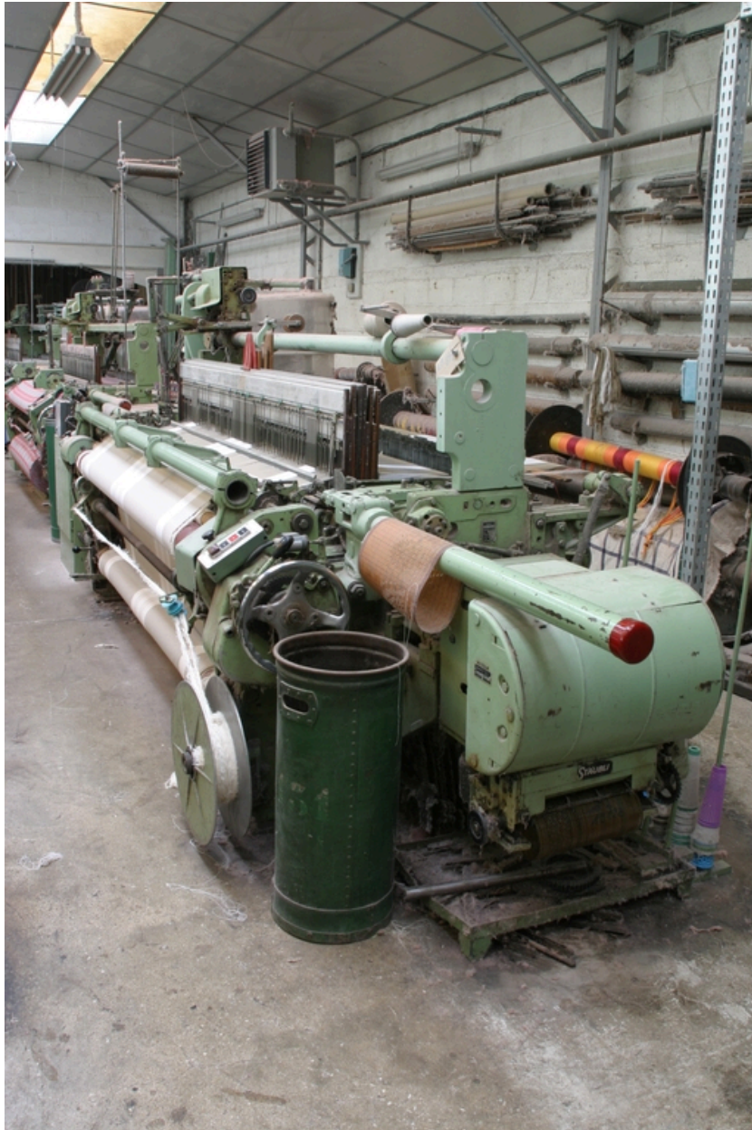
Machine à tisser à pinces Dornier n°7, construite en 1971.
