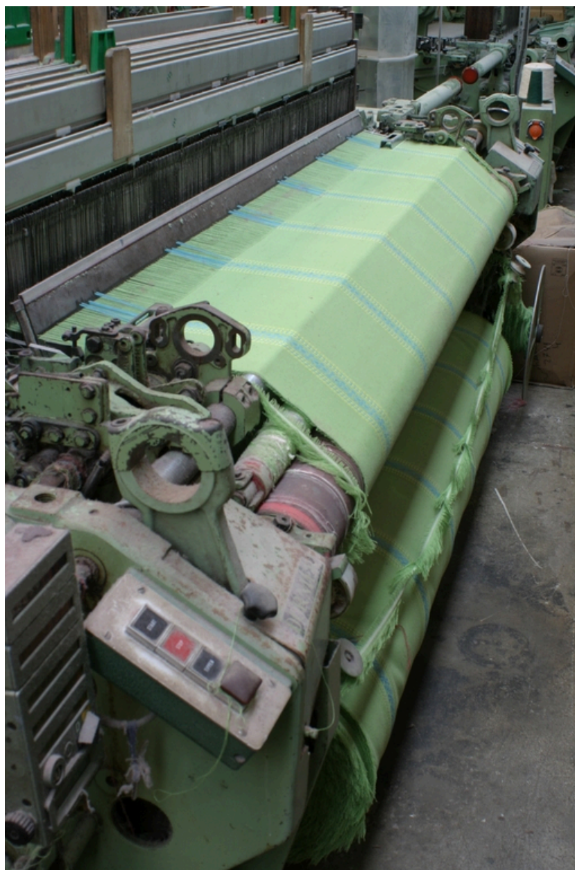
Machine à tisser à pinces Dornier montée avec deux ensouples : le tissu achevé s'enroule sur le rouleau toilier.
