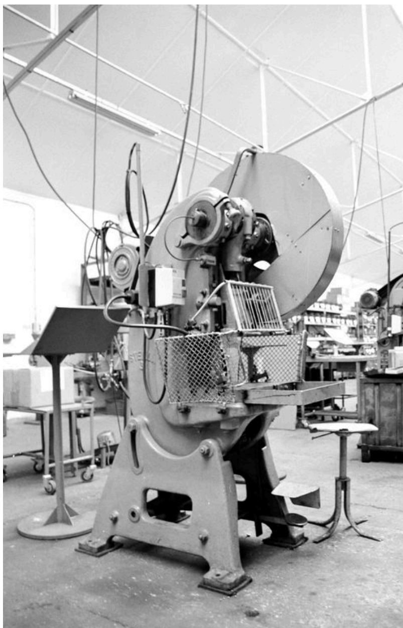
CRISOLLES. Usine de construction mécanique Lelong puis usine de roulements M.P.R. : presse d'emboutissage et de rivetage.
