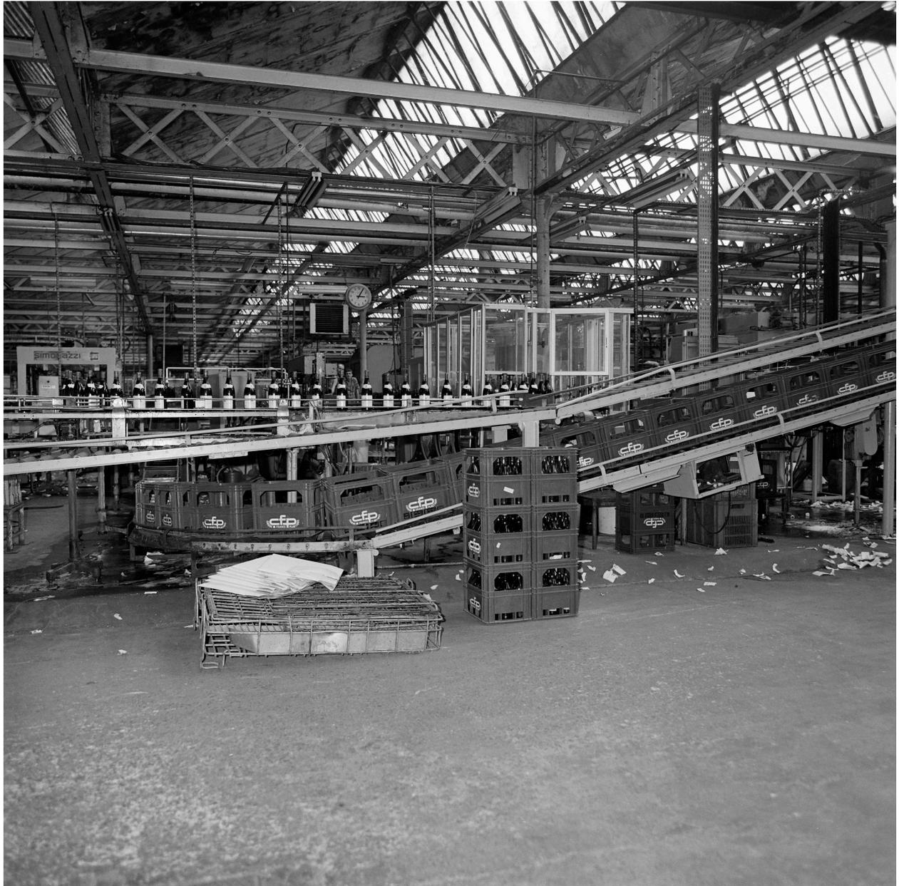
Atelier de fabrication, chaîne d'embouteillage.
