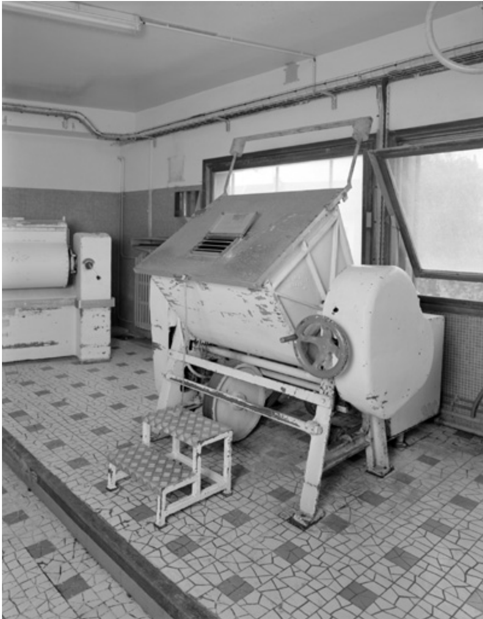
Pétrin n° 1, américain, vers 1930, de marque Westerman & Co, Chicago : vue du pétrin fermé.
