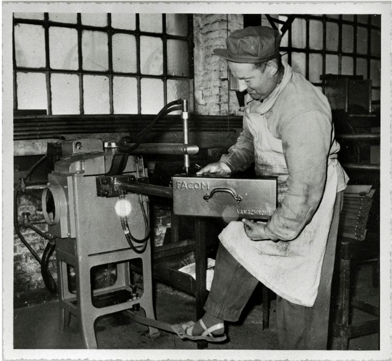
Ouvrier travaillant sur une soudeuse par points, en 1990.
