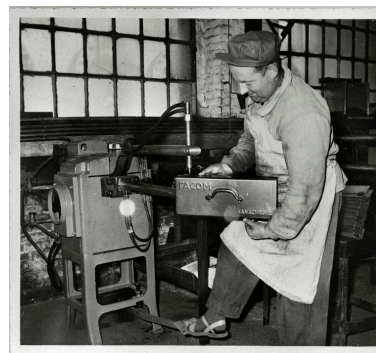
Ouvrier travaillant sur une soudeuse par points, en 1990. Phot. Thierry Lefébure IVR22_19908001593XB
