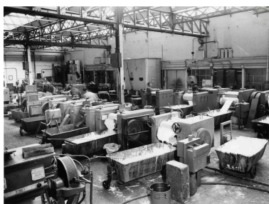
Broyeuses trois cylindres, vers 1950 (archives d'entreprise). Phot. Clarisse Lorieux IVR22_20086005190NUCAB
