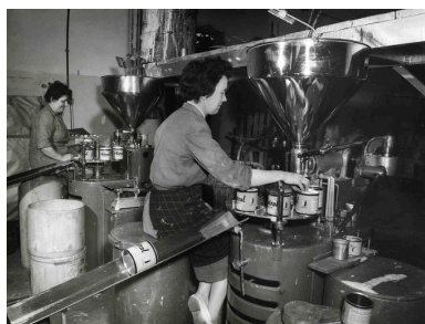
Remplissage automatique des boîtes, vers 1950 (archives d'entreprise). Phot. Clarisse Lorieux IVR22_20086005192NUCAB
