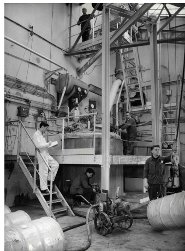
Fabrication des glycérophthaliques par système azéotropique, vers 1950 (archives d'entreprise). Phot. Clarisse Lorieux IVR22_20086005188NUCAB
