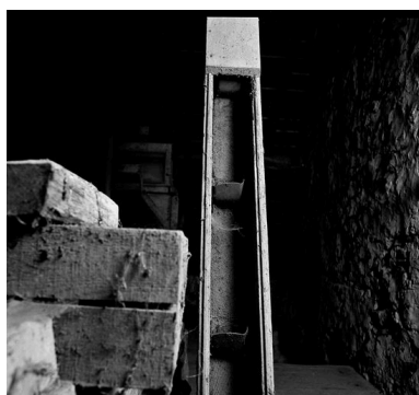
Elévateur à godets. Phot. Olivier Coquelle IVR22_19946000897X
