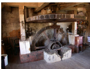
Intérieur du rez-de-chaussée, vue du système principal de transmission par engrenages. Phot. Bertrand Fournier IVR22_20026000799NUCA
