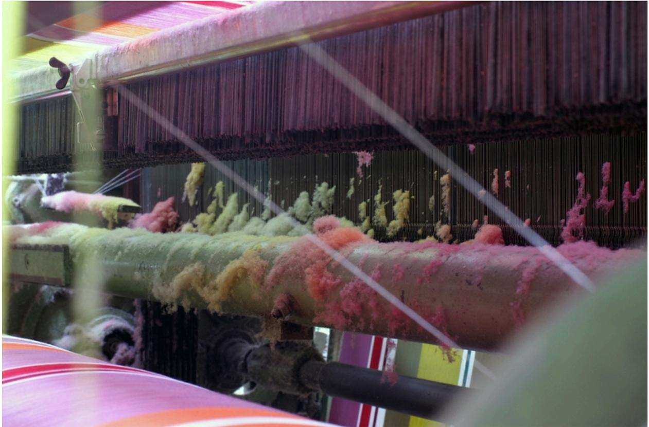
Les fils de chaîne, déroulés de l'ensouple (en bas à gauche), orientés par le porte-fils, sont chevauchés par les casse-chaînes à lamelle (au centre), avant de passer dans les lisses (à droite).
