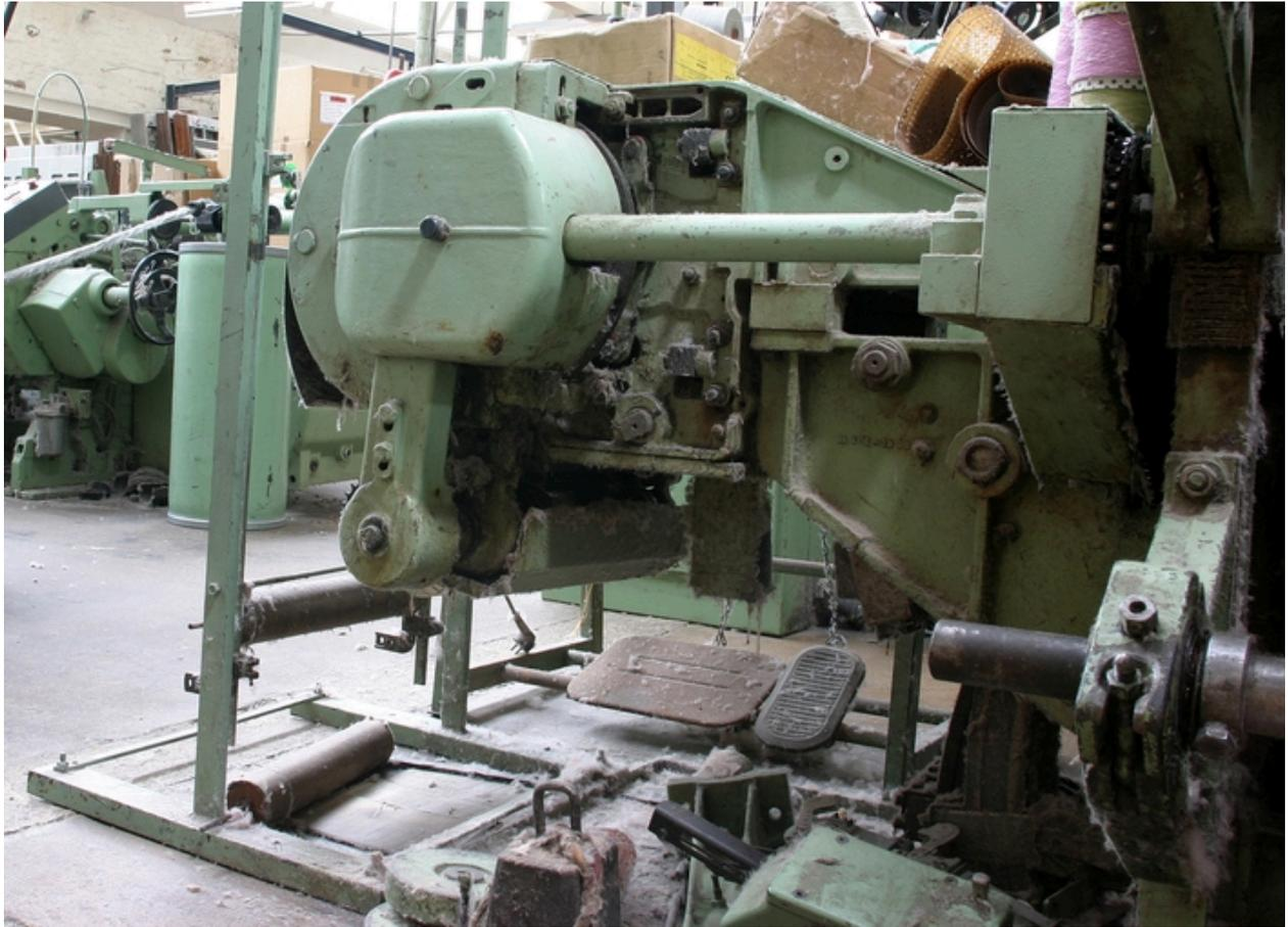
Ratière (mécanisme d'armure) Stäubli de la machine à tisser.
