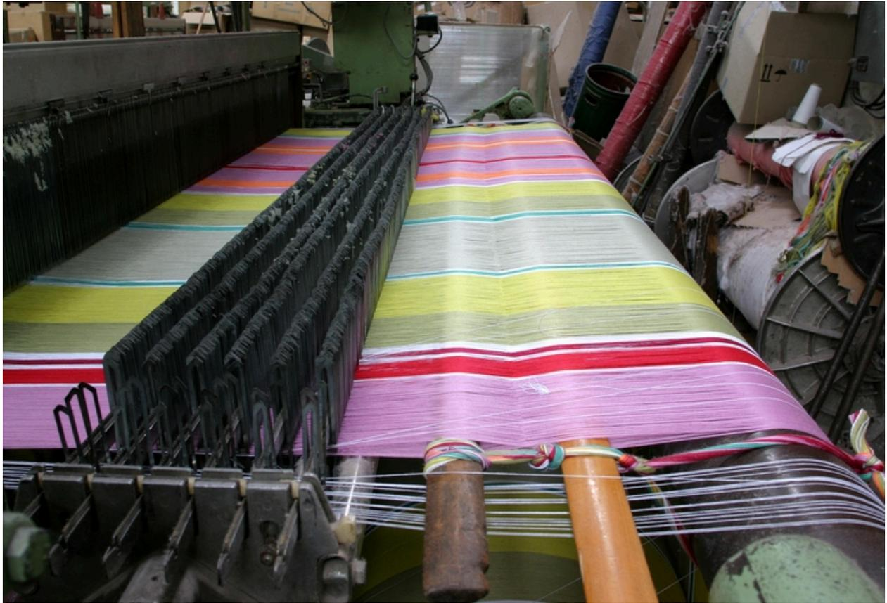
Les fils de chaîne, orientés par le porte-fils (cylindre à droite) et traversés par les baguettes d'encroix, sont chevauchés par les casse-chânes à lamelles (au centre) avant de passer dans les oeillets des lisses (à gauche).
